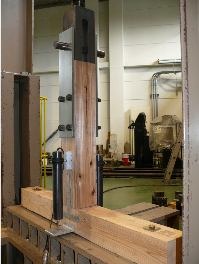
写真1 かど金物の引張試験
