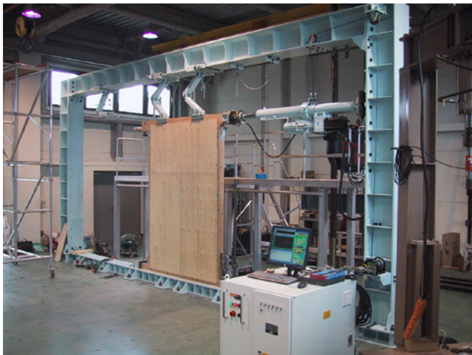
写真1 耐力壁の面内せん断試験
