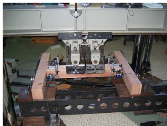
写真5 梁—梁の逆せん断試験
