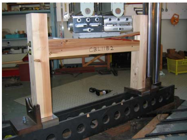
写真4 柱—梁の逆せん断試験
