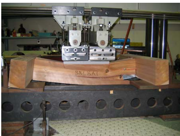
写真6 梁小口の割裂①
