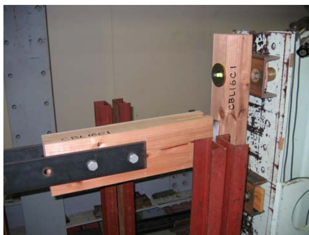
写真3 柱—梁の引張試験
