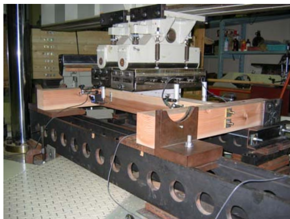
写真2 梁—梁のせん断試験
