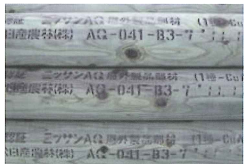
環境パイルの杭材
