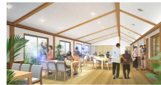
ダイルーム内観 床、腰壁、建具等の内装を木質化し温かみのあるしつらえとするともに、転倒時の床・壁の安全性を向上
