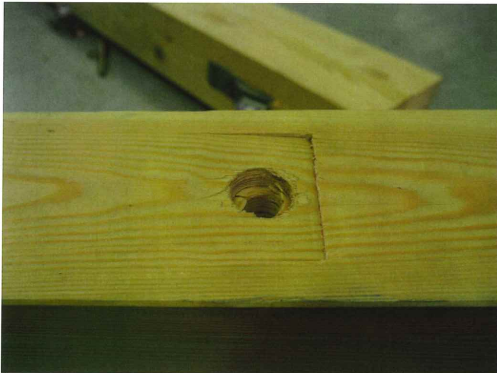
写真 2.22 T-HD 試験終了後 座金のめり込み
