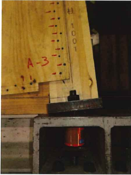
写真 1.19 A-3 試験終了後 柱脚の浮き上がり
