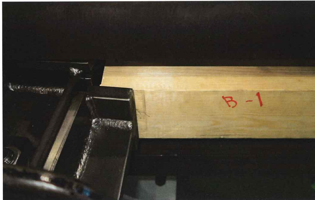
写真 1. 30 B-1 試験終了時 柱脚部の浮き上がり
