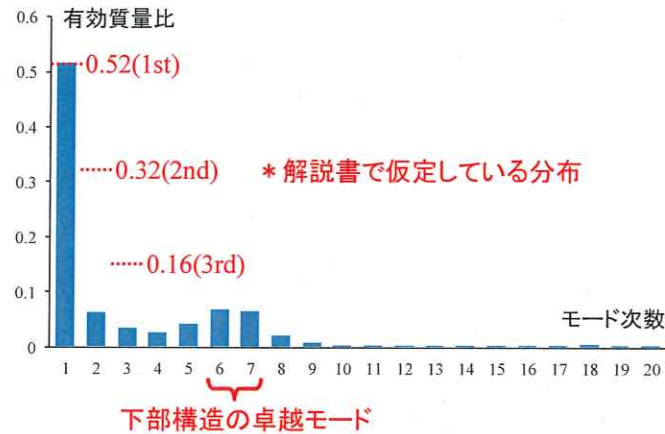
図 3.1-6 連続体モデルの解析解による各次モードの有効質量比
