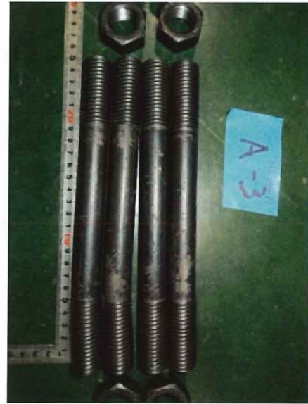
写真 1.20 A-3 試験終了後 アンカーボルト 部分的な黒皮の剥がれ
