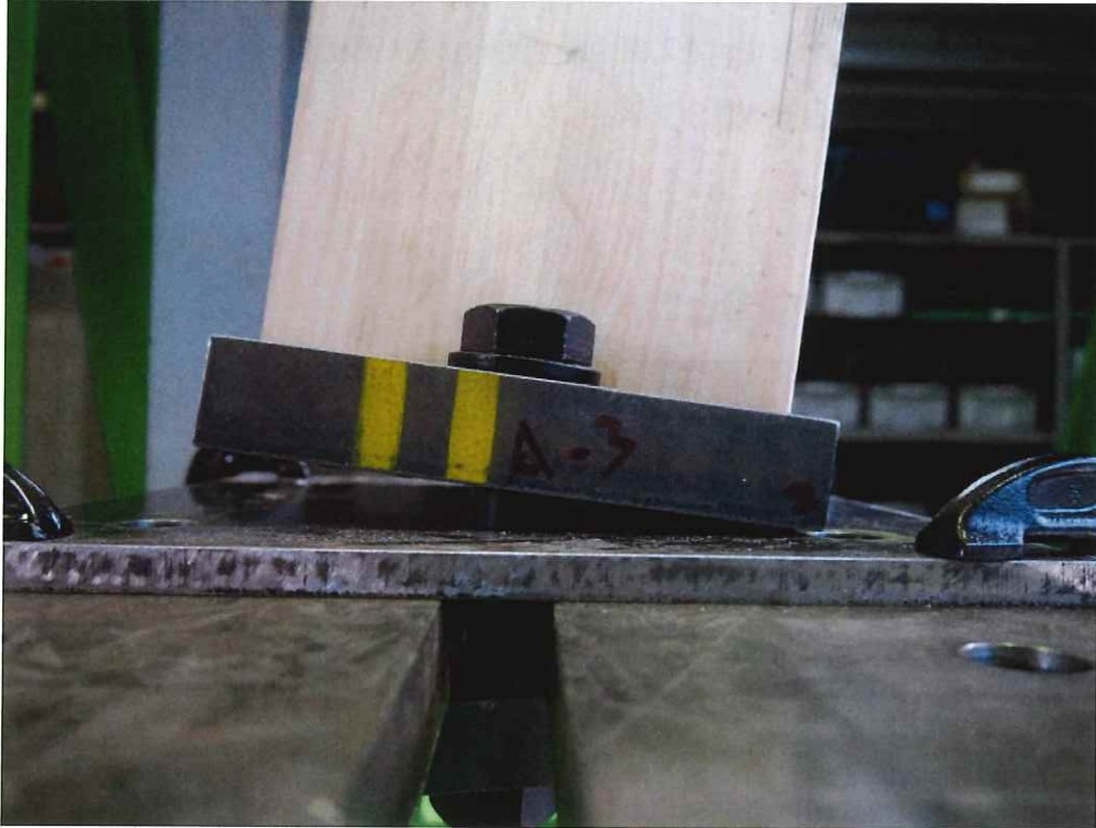
写真 2.17 M-CB 試験終了後 柱脚部拡大
