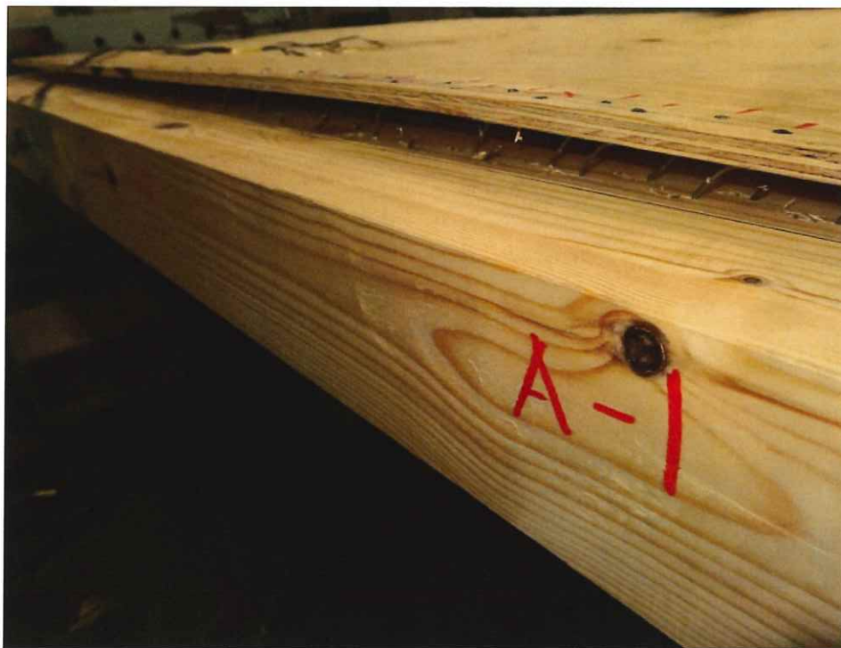
写真 1.6 A-1 試験終了後 面材の浮き
