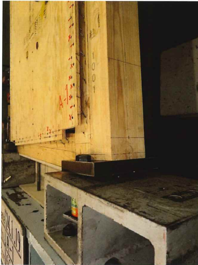
写真 1.5 A-1 試験終了後 柱脚の浮き上がり、釘の抜け、釘の破断、釘頭のめり込み
