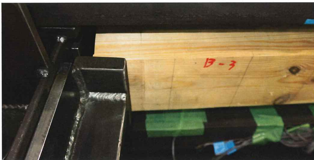
写真 1.44 B-3 試験終了時 柱脚部の浮き上がり
