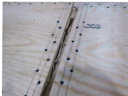
写真 1.23 A-3 試験終了後 中棧の割れ
