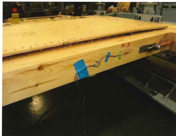
写真 1.21 A-3 試験終了後 面材の浮き
