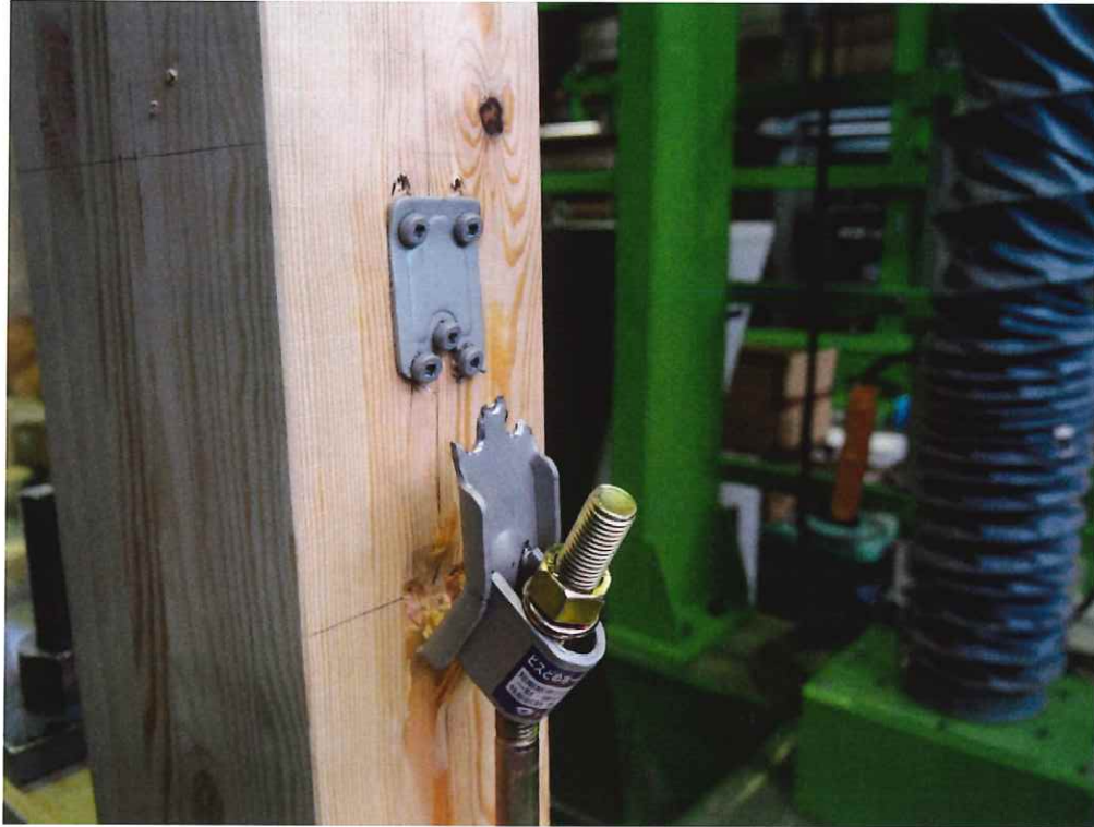
写真 2.21 T-HD 試験終了後 ホールドダウン金物の破壊
