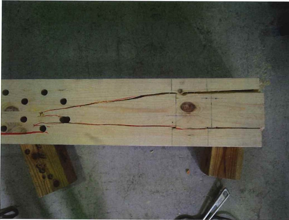
写真 2.13 T-CB-3 試験終了後 ビス接合部の集合型破壊
