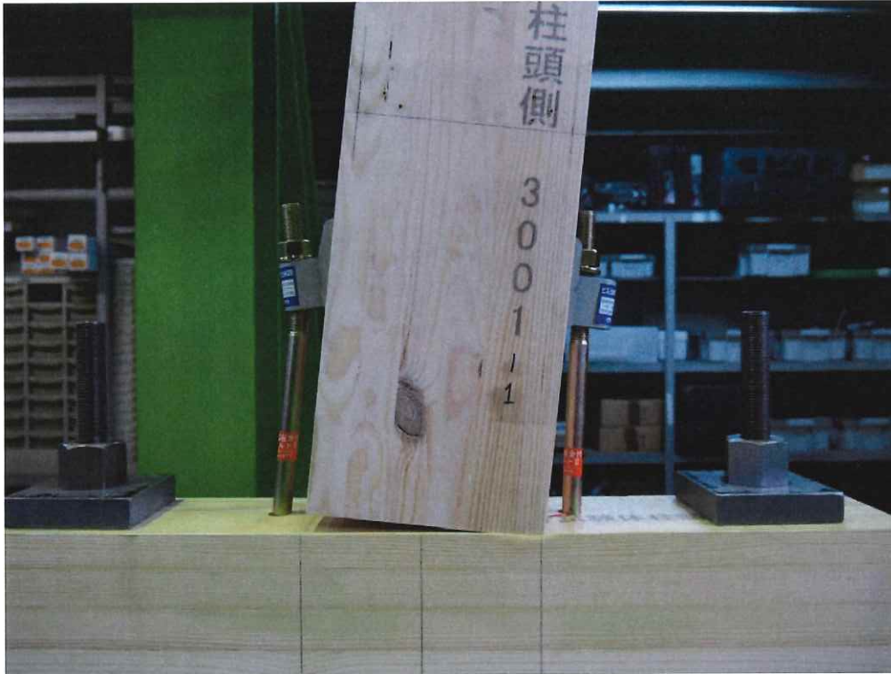
写真 2.25 M-HD-1 試験終了後 柱の浮き上がりと梁へのめり込み、アンカーボルトの変形
