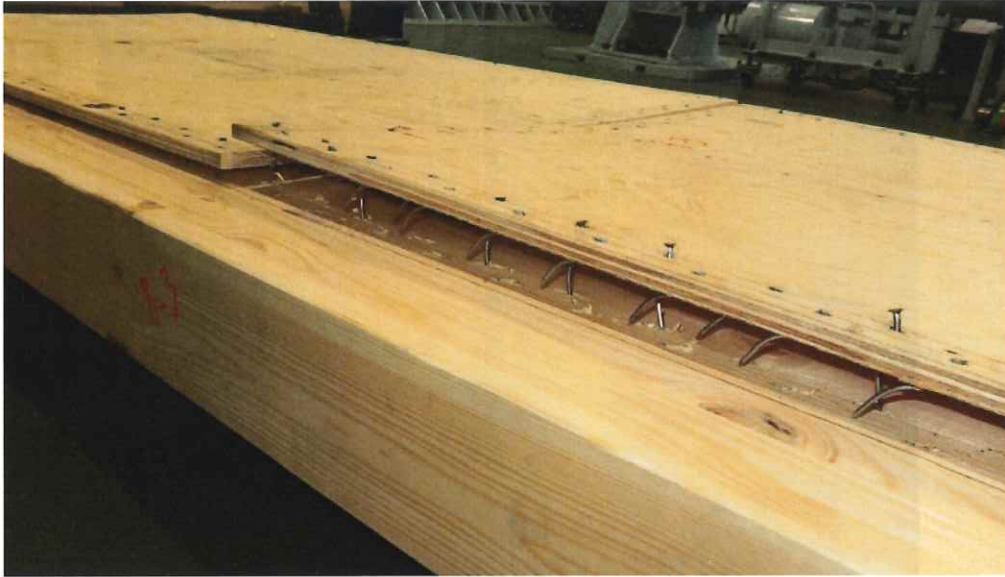
写真 1.42 B-3 試験終了後 面材の浮き
