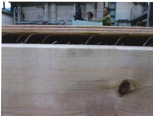
写真 1.22 A-3 試験終了後 釘の抜け、釘の破 断、パンチングアウト
