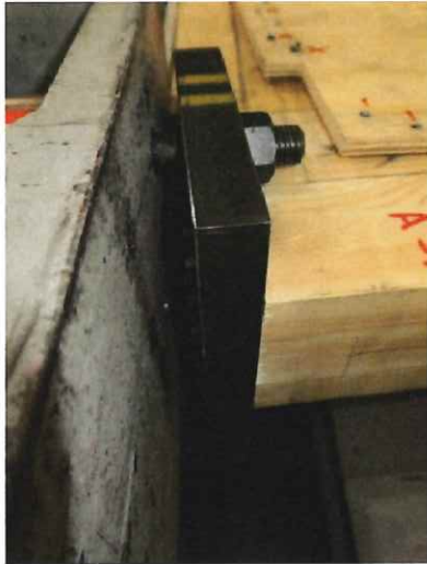
写真 1.11 A-2 試験終了後 柱脚の浮き上がり
