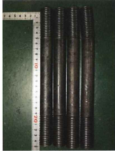
写真 1.12 A-2 試験終了後 アンカーボルト 黒皮の剥がれ
