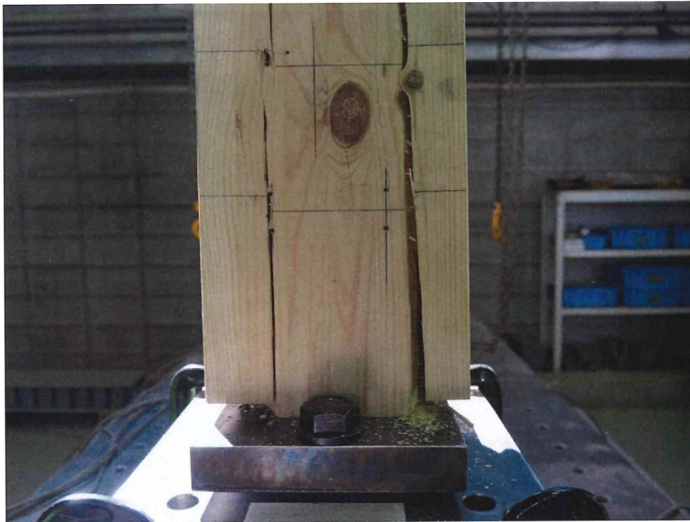
写真 2.12 T-CB-3 試験終了後 ビス接合部の集合型破壊
