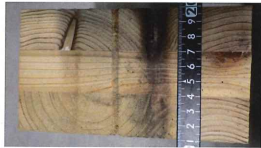
写真 1-54 仕様 16 の CLT 断面 (複合 コーチボルト M9+鉄平板 t4.5)
