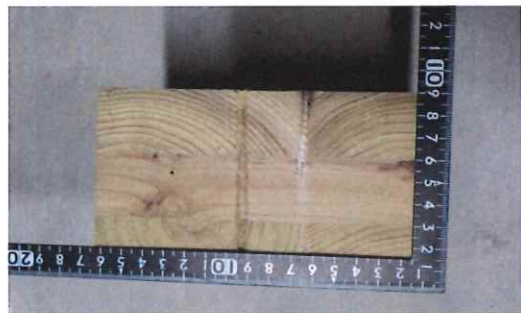
写真 1-48 仕様 13 の CLT 断面 (複合 コーススレッドビス L90+鉄曲平板 t1.6)
