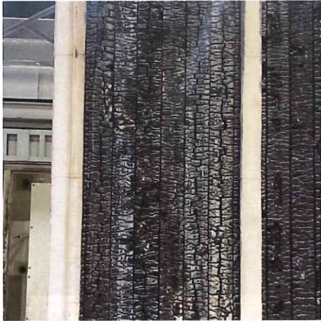
写真 21 加熱面・脱炉直後の解体時 全景 (仕様 1 ヒノキ CLT 厚 90)
