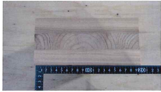
写真 3-50 仕様 22 の CLT 断面 (胴縁 留め具なし)
