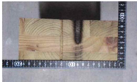
写真 1-36 仕様 8 の CLT 断面 (単独 コーチボルト M9,L90)
