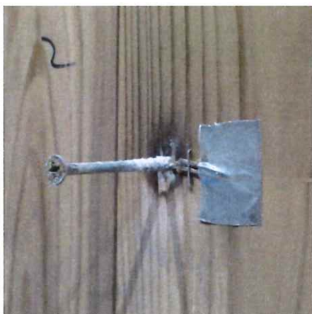
写真 1-25 仕様 3 の解体時（CLT 表面） （単独 コーススレッドビス L90）
