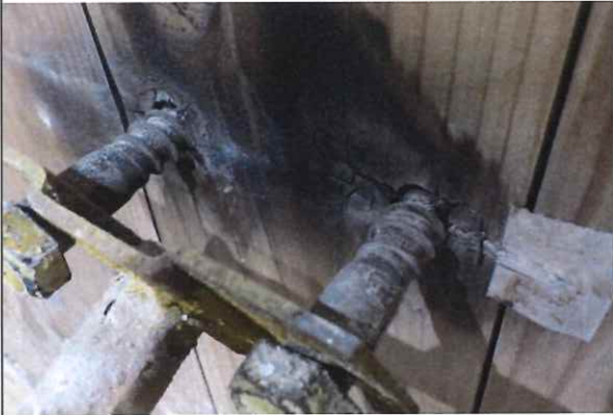
写真 1-57 仕様 18 の解体時 (CLT 表面) (複合・協会 コーチボルト M16+足 A)
