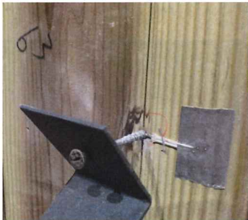
写真 1-47 仕様 13 の解体時 (CLT 表面) (複合 コーススレッドビス L90+鉄曲平板 t1.6)
