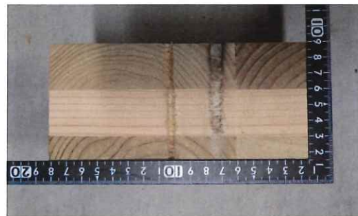
写真 1-42 仕様 26 の CLT 断面 (単独 パネリード (PX8-110 ))
