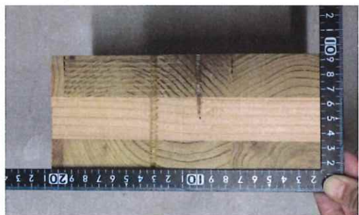
写真 1-26 仕様 3 の CLT 断面 （単独 コーススレッドビス L90）
