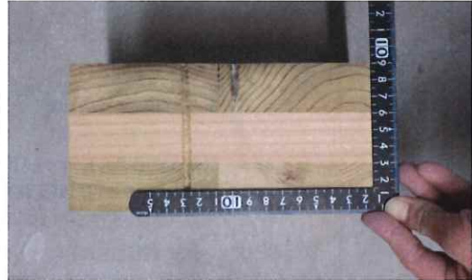
写真 1-22 仕様 1 の CLT 断面 （単独 N65 くぎ）
