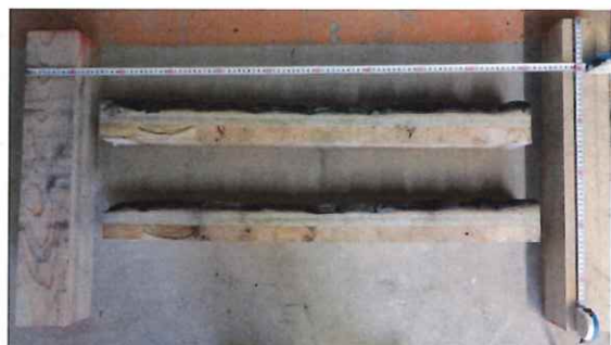
写真 32 解体時の CLT 断面 (仕様 4 スギ+硬質木片セメント板 CLT 厚 85) (上段：上部熱電対位置、下段：下部熱電対位置)
