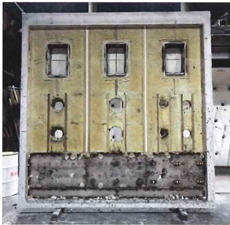
写真 1-81 加熱面・脱炉直後の解体時 (開口小口・貫通部の胴縁・断熱材)
