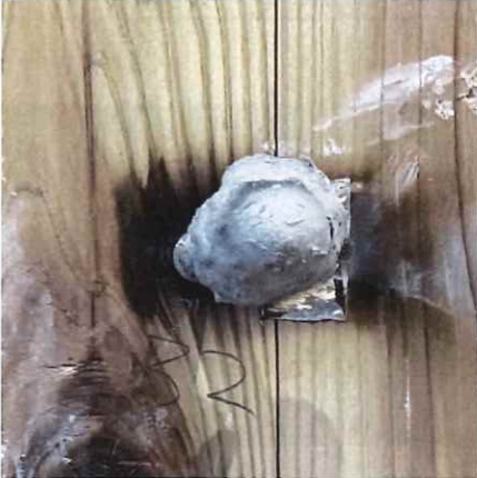
写真 2-43 仕様 20 の解体時 (CLT 表面) (直貼 コーチボルト M16+AS ボンドカバー)
