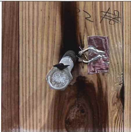
写真 2-23 仕様 10 の解体時 (CLT 表面) (胴縁 コーチボルト M16/L100)
