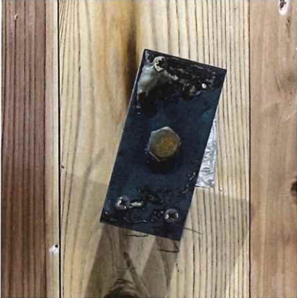
写真 2-49 仕様 23 の解体時 (CLT 表面) (直貼 コーチボルト M9+鉄板+GW カバー)
