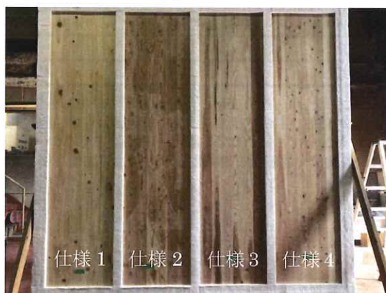
写真1 試験体（30分耐火構造外壁）
