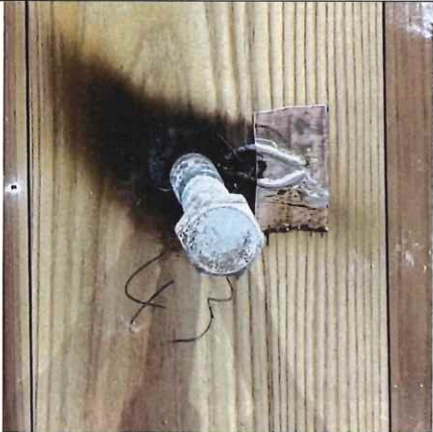
写真 2-65 仕様 31 の解体時 (CLT 表面) (直貼 コーチボルト M16+GBF-(V)12.5)
