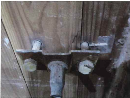
写真 1-65 仕様 22 の解体時 (CLT 表面) (複合・協会 M12 貫通ボルト+ナット+足 B)
