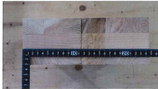
写真 2-36 仕様 16 の CLT 断面 (胴縁 留め具なし)
