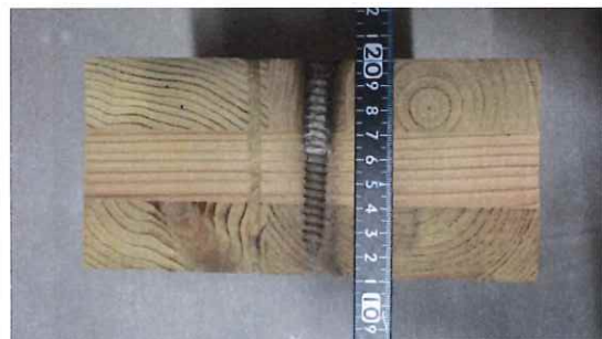
写真 1-36 仕様 8 の CLT 断面 (単独 コーチボルト M9,L90)
