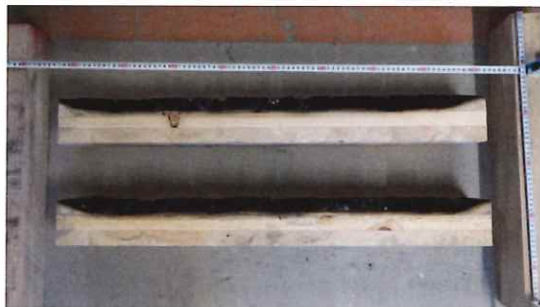
写真 29 解体時の CLT 断面 (仕様 1 ヒノキ CLT 厚 90) (上段：上部熱電対位置、下段：下部熱電対位置)
