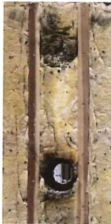
写真 1-15 仕様 5,6 の解体時 (胴縁) (かぶせタイプ GB-F(V)21mm 厚×2 枚+RW)
