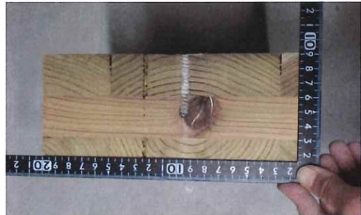
写真 1-34 仕様 7 の CLT 断面 (単独 コーチボルト M6)
