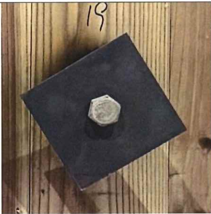
写真 2-17 仕様 7 の解体時 (CLT 表面) (胴縁+断熱材 コーチボルト M16+鉄板薄)
