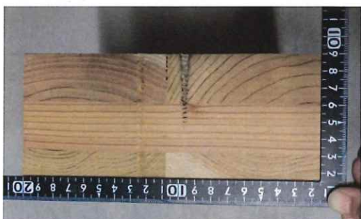
写真 1-32 仕様 6 の CLT 断面 (単独 パネリード (P6-120 II+))
