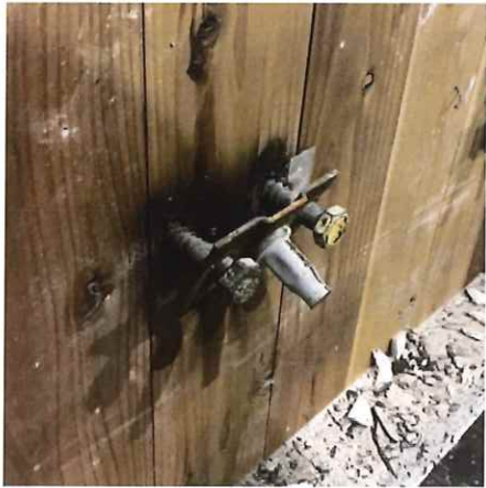
写真 1-63 仕様 21 の解体時 (CLT 表面) (複合・協会 コーチボルト M16+足 B)
