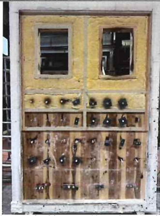
写真 2-83 加熱面・脱炉直後の解体時 (胴縁・断熱材)
