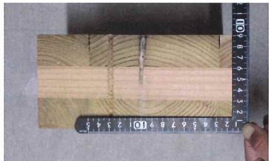
写真 1-24 仕様 2 の CLT 断面 （単独 N90 くぎ）
