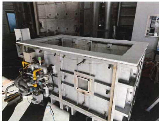
写真 8 ベターリビングの小型炉（非載荷）
