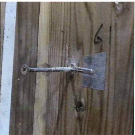
写真 1-43 仕様 11 の解体時 (CLT 表面) (複合 コーススレッドビス L90+木胴縁)
