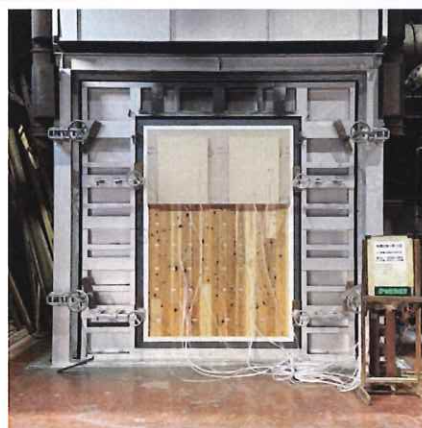
写真 2-78 加熱面・脱炉時 (1 時間加熱・4 時間放置)
