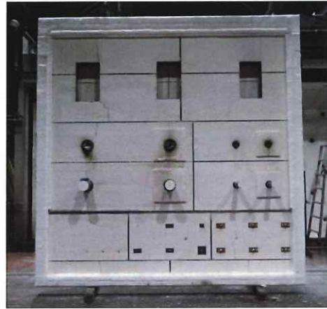
写真 1-74 加熱面・脱炉時 (1時間加熱・6時間放置)
