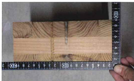
写真 1-30 仕様 5 の CLT 断面 (単独 パネリード (P6-90 II+))
