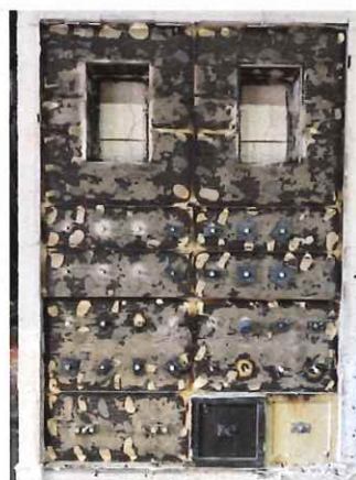
写真 2-82 加熱面・脱炉直後の解体時 (下張材)
