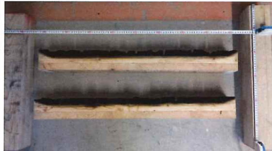
写真 30 解体時の CLT 断面 (仕様 2 カラマツ CLT 厚 90) (上段：上部熱電対位置、下段：下部熱電対位置)
