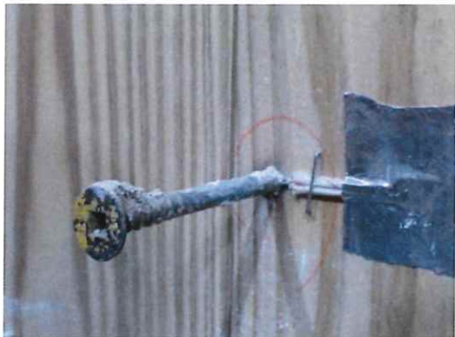
写真 1-67 仕様 23 の解体時 (CLT 表面) (複合・協会 パネリード(P6-110 II+))
