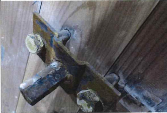
写真 1-59 仕様 19 の解体時 (CLT 表面) (複合・協会 M12 貫通ボルト+ナット足 A)
