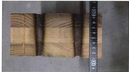
写真 1-66 仕様 22 の CLT 断面 (複合・協会 M12 貫通ボルト+ナット+足 B)
