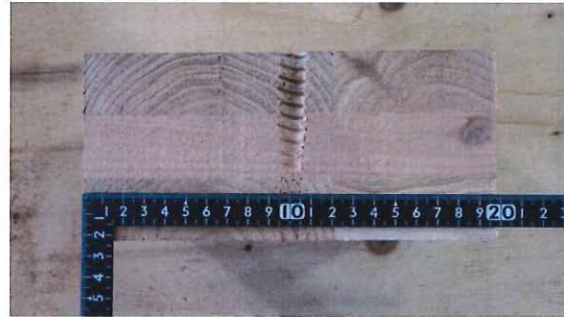
写真 2-42 仕様 19 の CLT 断面 (直貼 コーチボルト M16+AES カバー)
