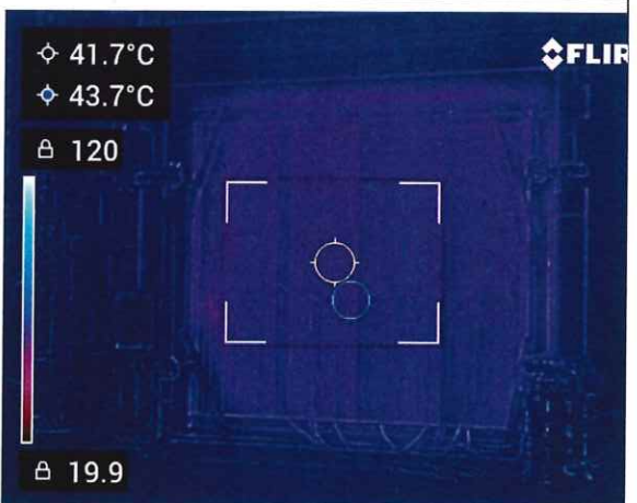
写真 20 非加熱面・実験開始 360 分後 (熱映像) (実験終了時)
