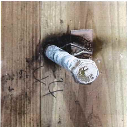
写真 2-65 仕様 31 の解体時 (CLT 表面) (直貼 コーチボルト M16+GBF-(V)12.5)
