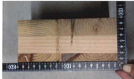
写真 1-28 仕様 4 の CLT 断面 (単独 コーススレッドビス L120)
