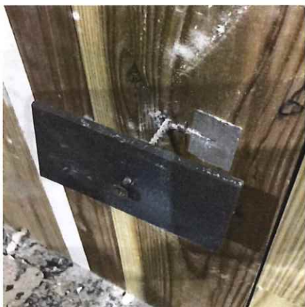
写真 1-49 仕様 14 の解体時 (CLT 表面) (複合 コーススレッドビス L90+鉄平板 t4.5)
