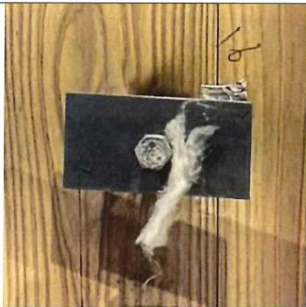
写真 2-11 仕様 4 の解体時 (CLT 表面) (胴縁+断熱材 コーチボルト M9+鉄板)
