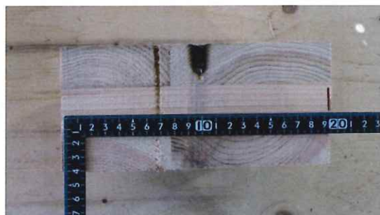
写真 2-64 仕様 30 の CLT 断面 (直貼 コーチボルト M9+GBF-(V)21)
