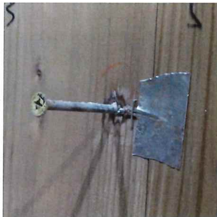
写真 1-27 仕様 4 の解体時 (CLT 表面) (単独 コーススレッドビス L120)
