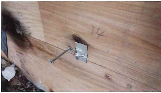
写真 3-25 仕様 10 の解体時 (CLT 表面) (直貼 コーススレッドビス L90)
