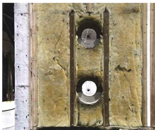
写真 1-9 仕様 1,2 の解体時（胴縁） （かぶせタイプ GB-F(V)21mm 厚×2 枚+RW）
