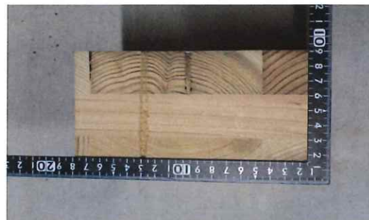
写真 1-44 仕様 11 の CLT 断面 (複合 コーススレッドビス L90+木胴縁)
