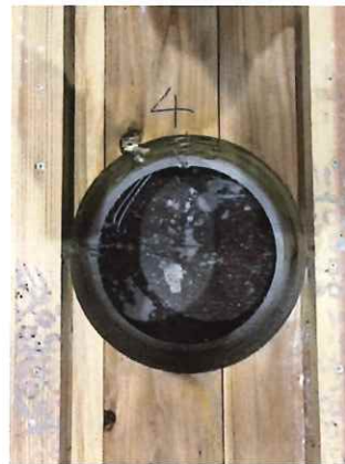
写真 1-14 仕様 4 の解体時 (CLT 躯体) (増張タイプ 鋼管 100,GB-F(V)21mm 厚×2 枚+RW)
