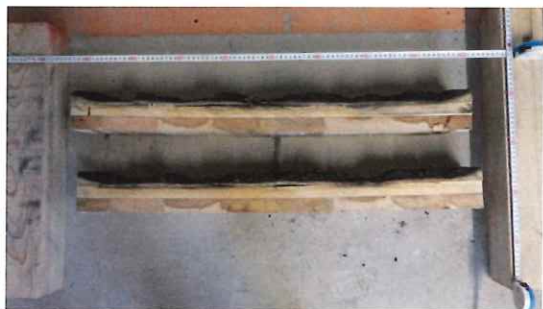
写真 31 解体時の CLT 断面 (仕様 3 スギ+不燃処理スギ材 CLT 厚 85 ) (上段：上部熱電対位置、下段：下部熱電対位置)
