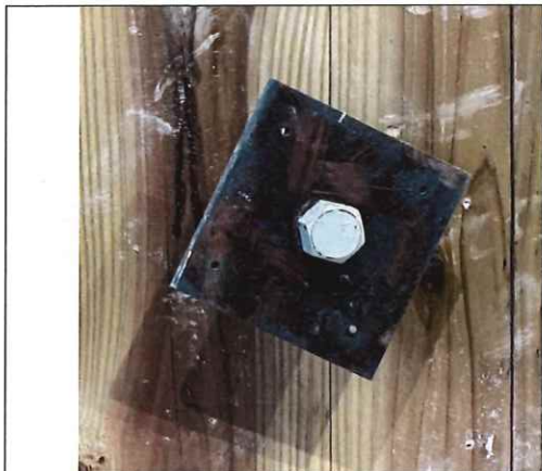
写真 2-59 仕様 28 の解体時 (CLT 表面) (直貼 コーチボルト M16+鉄板大+RW カバー)
