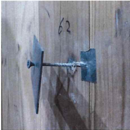
写真 1-45 仕様 12 の解体時 (CLT 表面) (複合 コーススレッドビス L90+鉄平板 t1.6)
