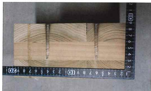
写真 1-56 仕様 17 の CLT 断面 (複合・協会 パネリード(P6-110 II+)+足 A)
