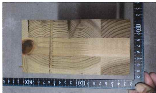
写真 1-50 仕様 14 の CLT 断面 (複合 コーススレッドビス L90+鉄平板 t4.5)
