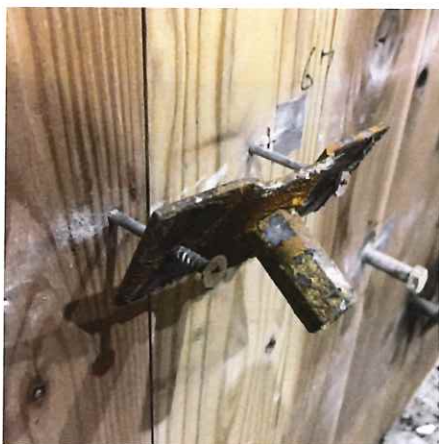
写真 1-55 仕様 17 の解体時 (CLT 表面) (複合・協会 パネリード(P6-110 II+)+足 A)
