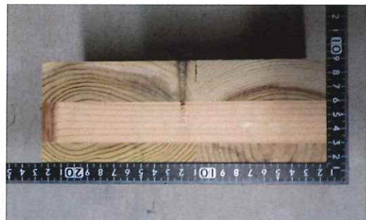
写真 1-68 仕様 23 の CLT 断面 (複合・協会 パネリード(P6-110 II+))
