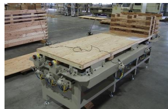
写真 2-3 真壁パネル(製作器具)
