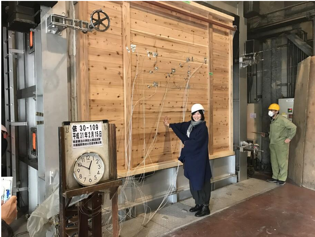
写真2-1 スギ板厚さ40mm×2枚の落とし込み板壁の加熱実験の様子（日本板倉建築協会）加熱50分後に裏面温度は50℃程度。45分準耐火構造の性能を確保した。
