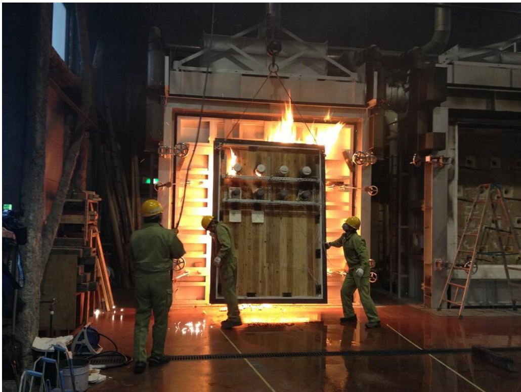
写真2-2 スギCLT厚さ150mmの加熱実験の様子。加熱120分後でも裏面温度は100℃程度。
