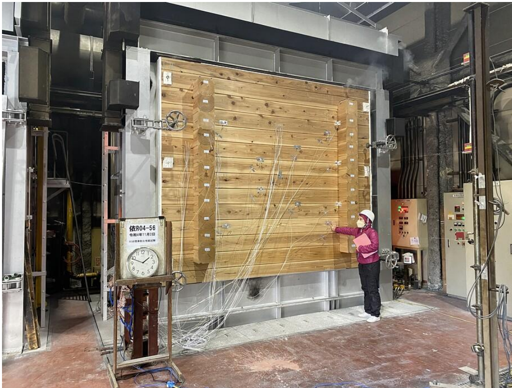
写真2-3 スギ240mm角のログ壁の加熱実験の様子（日本ログハウス協会）。加熱110分後でも裏面温度は加熱開始時から全く上昇せず。
