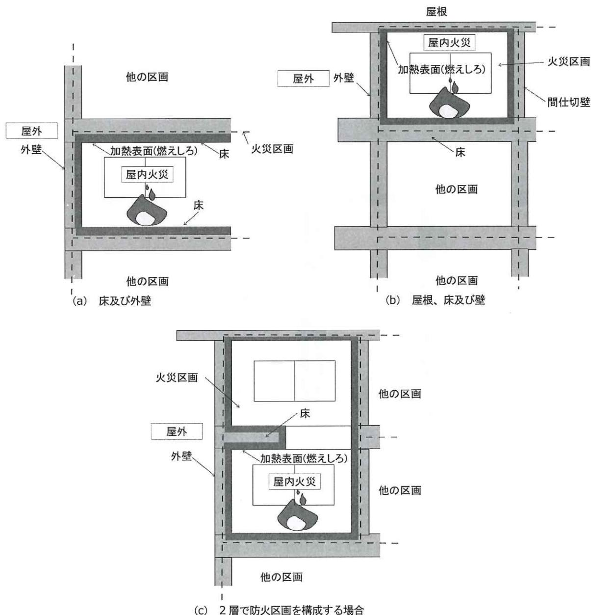
図 4.2.2-4 屋内火災における防火区画内の燃えしろ想定面（断面図）
