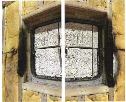
写真 1.3.2-64 加熱面・解体時 CLT 表面
