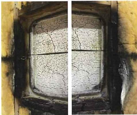
写真 1.3.2-63 加熱面・解体時 CLT 表面
