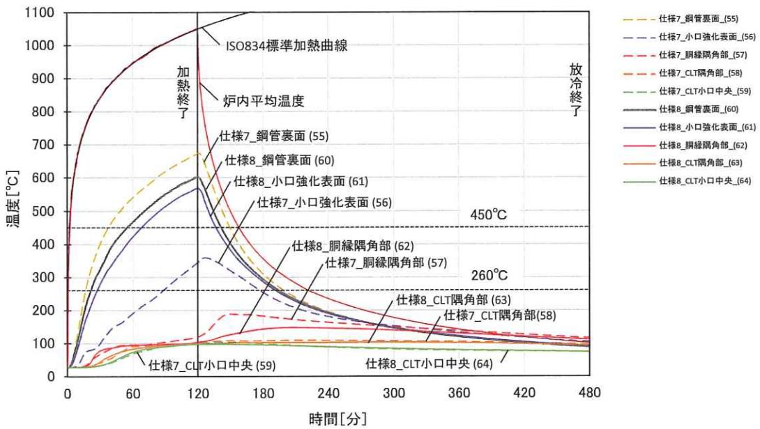
図 1.3.2-7 貫通部(鋼管 50A)の内部温度推移
