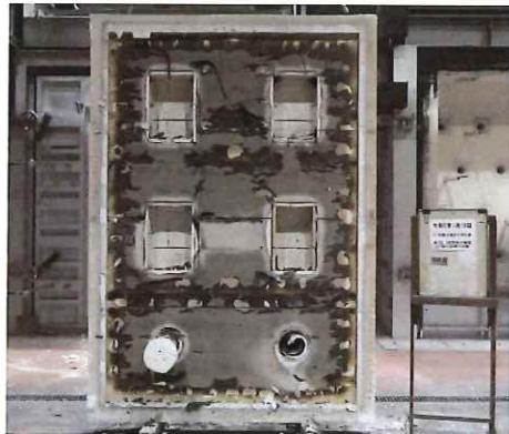
写真 1.3.2-122 加熱面・解体時
