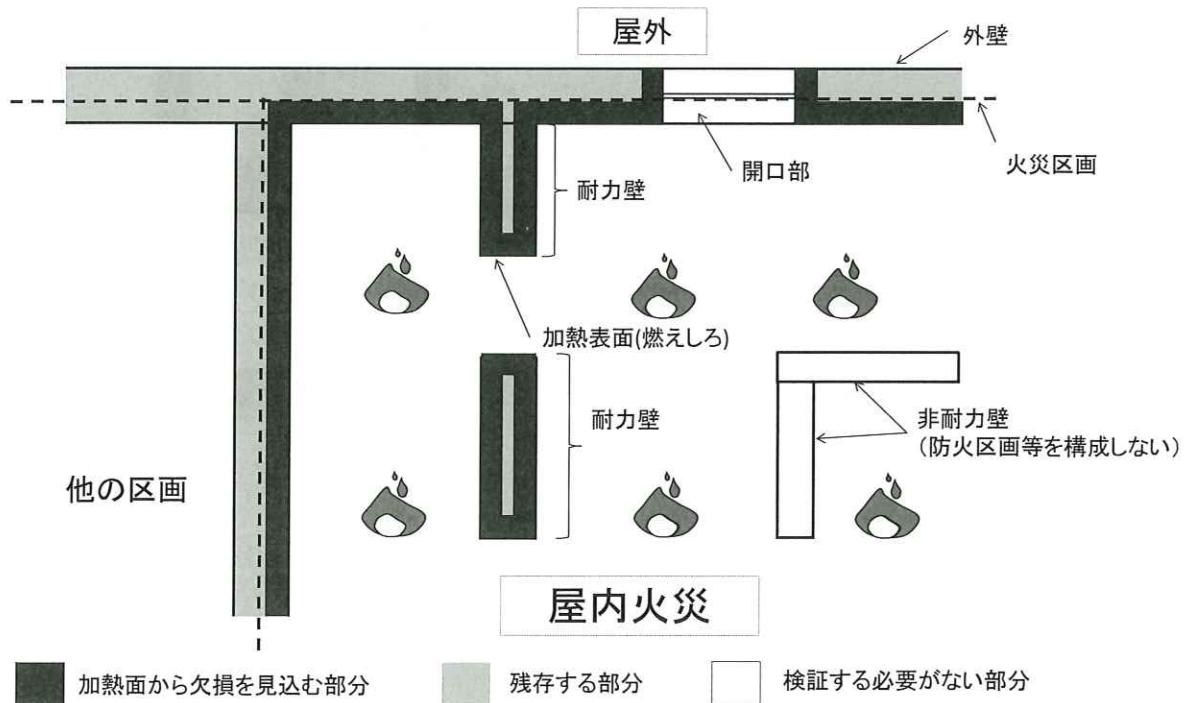
図 6.3.2-3 屋内火災における防火区画内の燃えしろ想定面（平面図）
