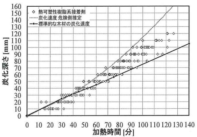
図 6.2.1 同一規格 JAS 材の加熱実験における炭化深さの既往の測定結果<sup>2)</sup>
