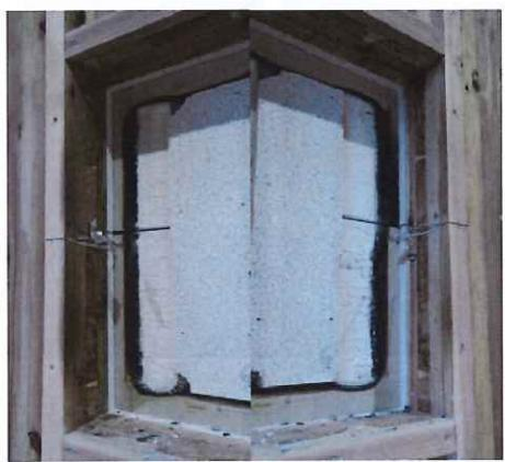
写真 1.3.2-183 加熱面・解体時 CLT 表面
