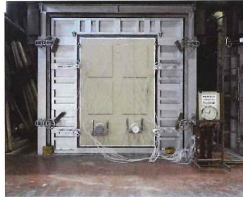
写真 1.3.2-87 非加熱面・加熱開始 45 分後
