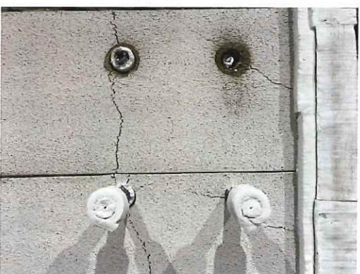
写真 1.3.2-60 加熱面・脱炉直後
