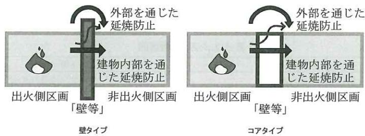
図 3.2.3-1 大規模木造建築物における壁等による延焼防止の考え方
