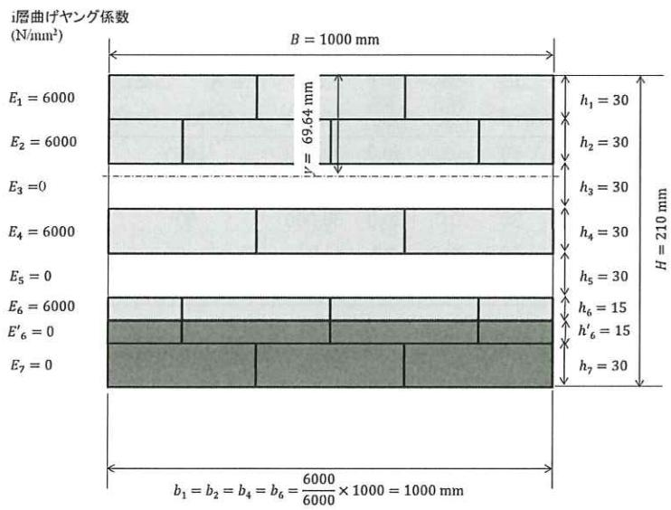
表 4.2.4-8 S60-5-7 (210mm) 積層方向の曲げ剛性・強軸の場合の計算例
