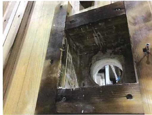
写真 1.3.2-75 加熱面・解体時 CLT 表面
