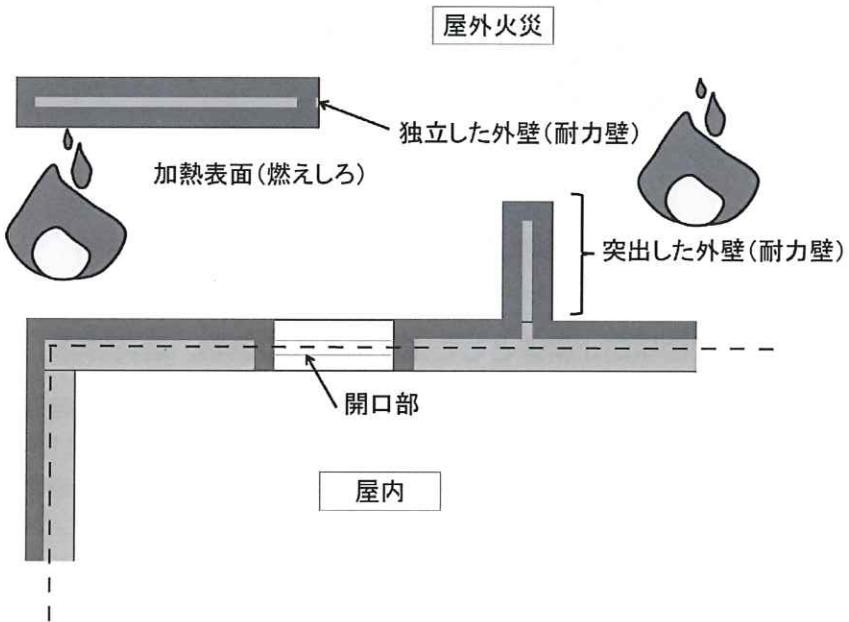
図 6.3.2-5 屋外火災における防火区画内の燃えしろ想定面（平面図）
