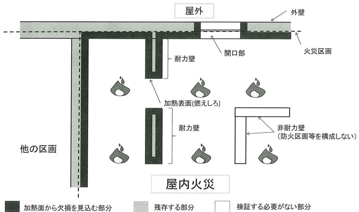
図 4.2.2-3 屋内火災における防火区画内の燃えしろ想定面（平面図）
