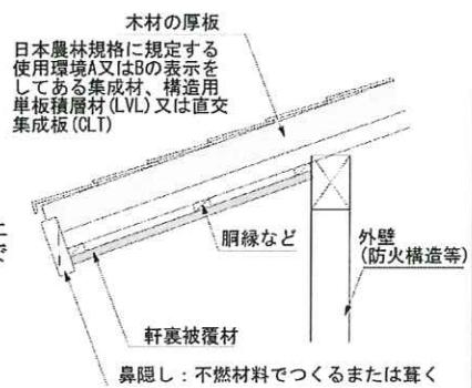
※CLT等外壁(防火構造)によって小屋裏又は天井裏と防火上有効に遮られている場合は軒裏被覆材を省略できる
