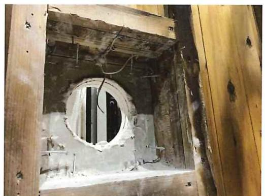
写真 1.3.2-71 加熱面・解体時 CLT 表面
