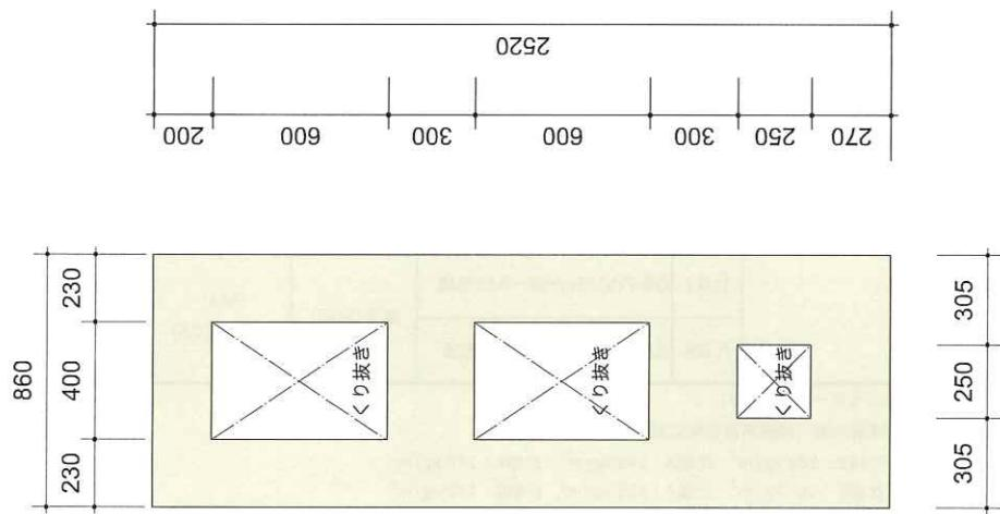
図 1.3.1-8 試験体 2 の CLT パネルの加工（単位：
