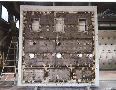
写真 1.3.2-168 加熱面・解体時
