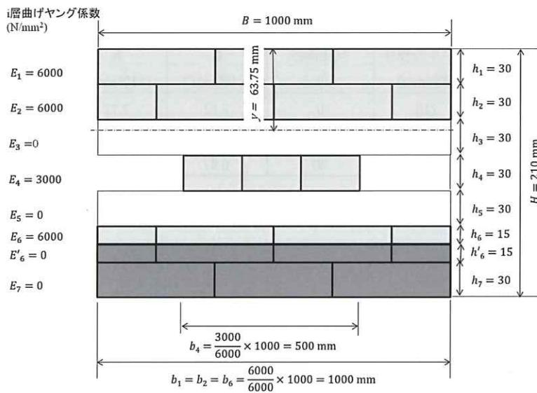
図 4.2.4-2 45 分燃えしろの残存断面
