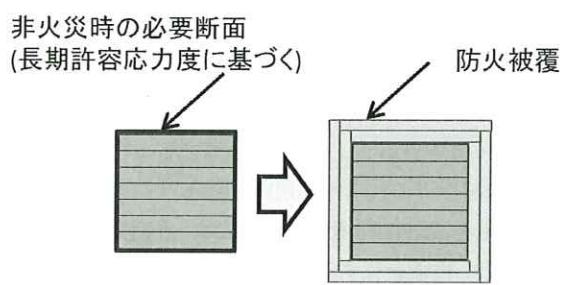
図4.1-1 燃えしろ設計とメンブレン防火被覆の概念
