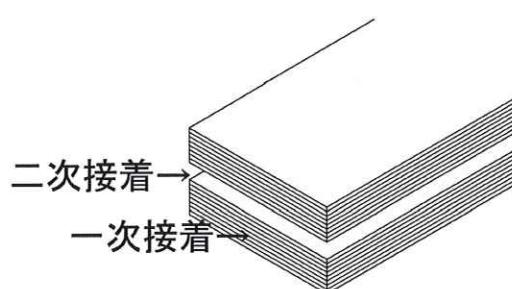
図 4.2.1-6 LVL パネルの接着 (1 次接着、2 次接着)
