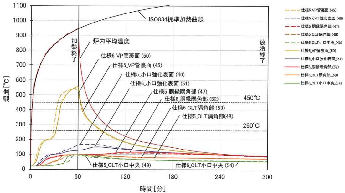
図 1.3.2-20 貫通部(VP 管 50A)の内部温度推移
