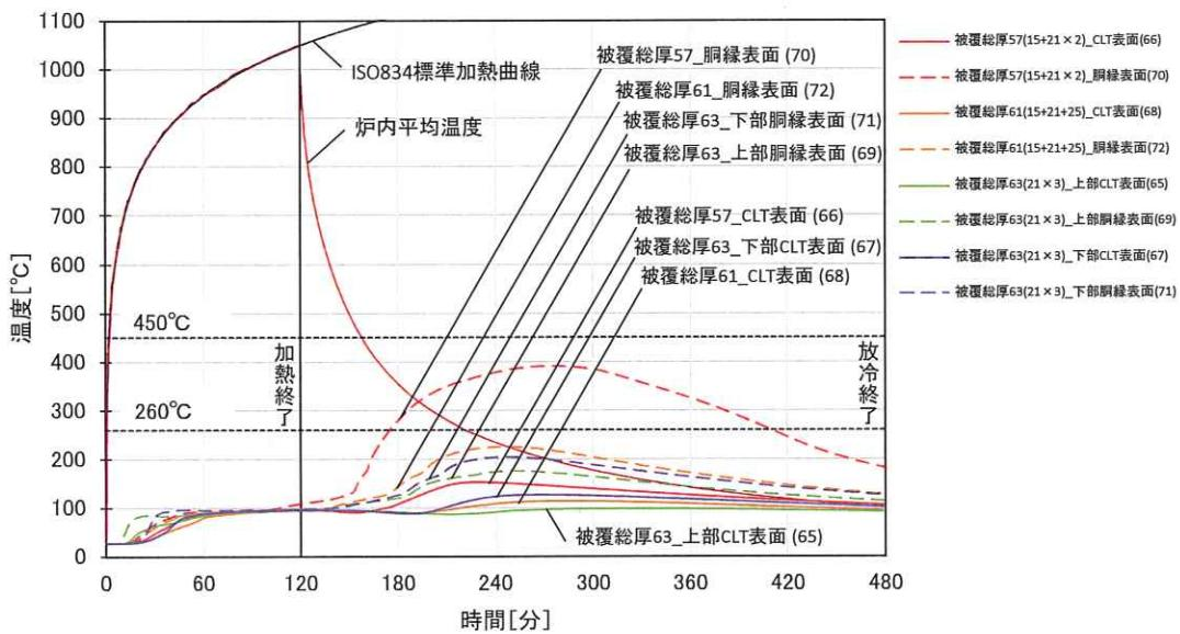
図 1.3.2-8 一般部の内部温度推移
