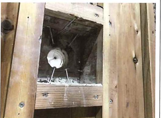
写真 1.3.2-81 加熱面・解体時 CLT 表面
