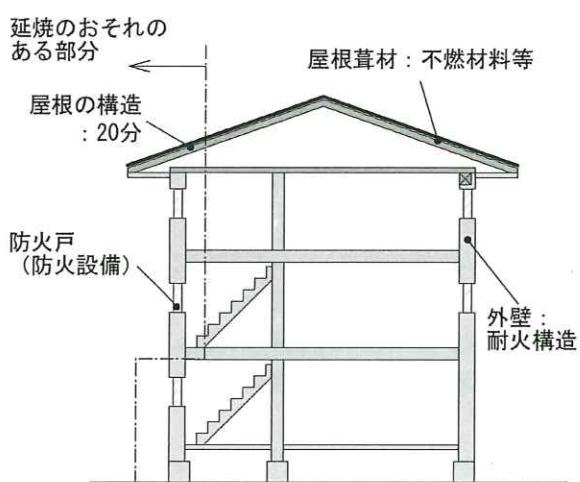
■ 口準耐火建築物 1号（外壁耐火構造）
