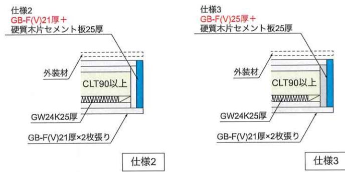
図 1.4-3 1 時間耐火構造壁に対する開口部小口の防火的な措置の例
