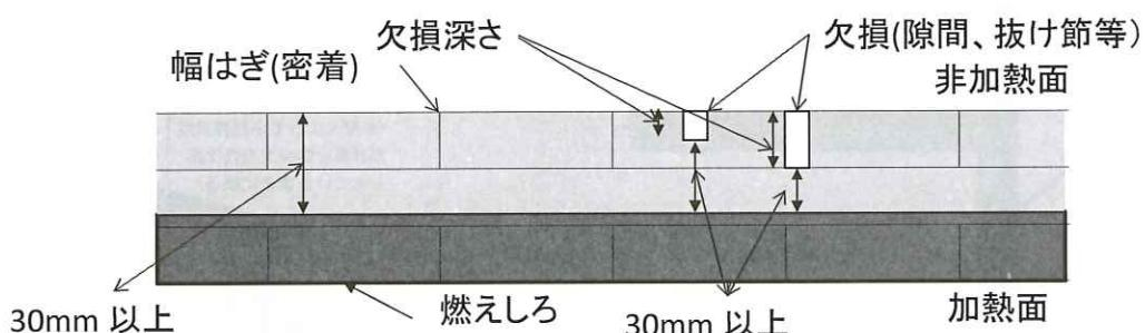
図4.2.3-1 遮熱性及び遮炎性を有するCLTパネルの残存断面の概念図
