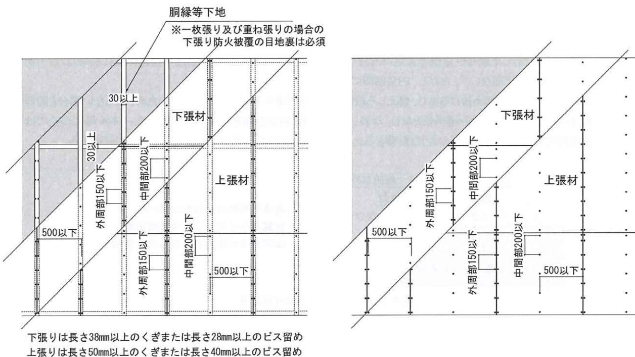
図5-1 準耐火構造壁の防火被覆の留め付け方法の一例
