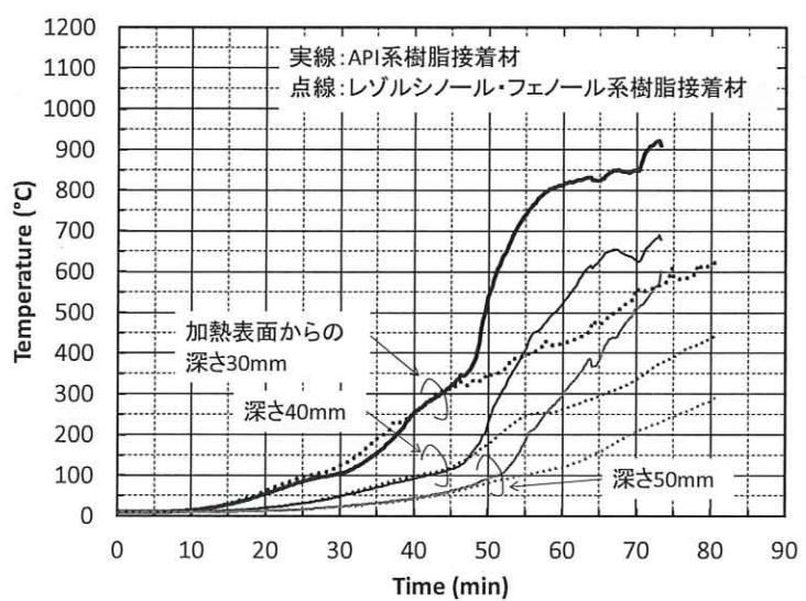
図 4.2.1-2 CLTパネルの部材内部温度
