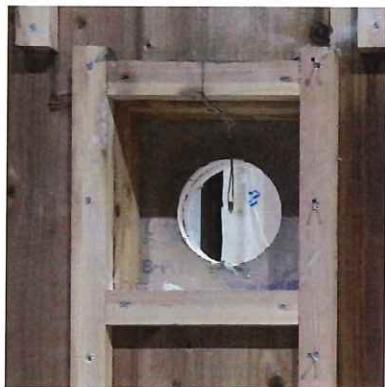
写真 1.3.2-187 加熱面・解体時 CLT 表面
