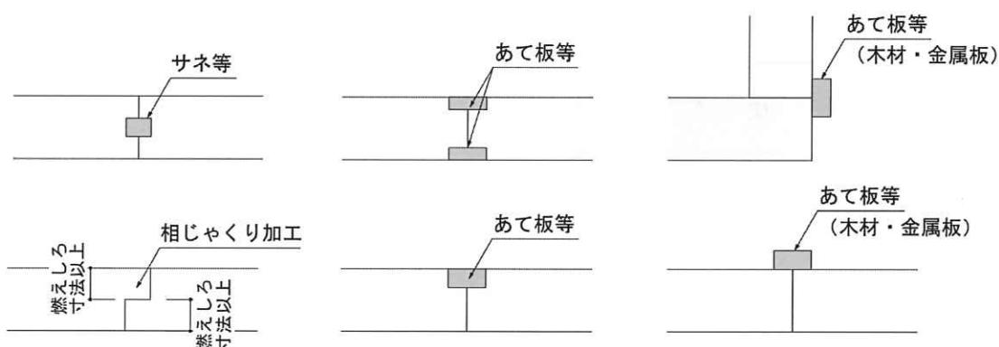
※CLTパネル等の突き付け部は隙間をなくすか塞ぐ。
