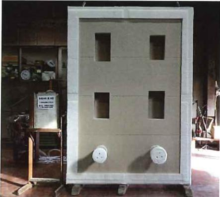
写真 1.3.2-120 加熱面・実験開始時
