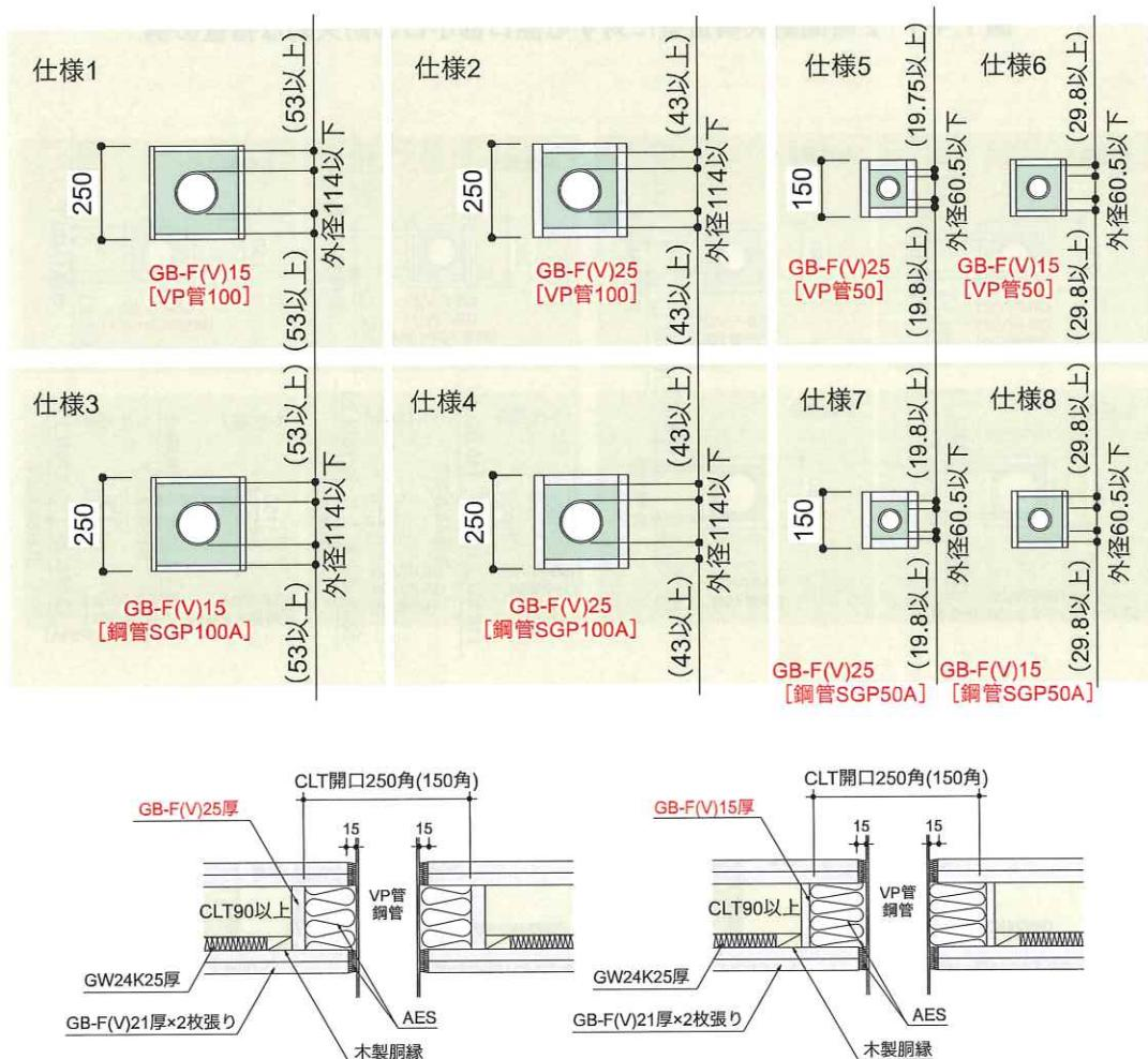
図 1.4-4 1 時間耐火構造壁に対する設備貫通部の防火的な措置の例
