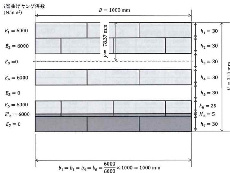
図 4.2.4-5 45 分燃えしろの残存断面
