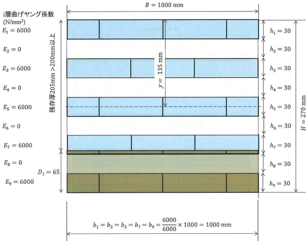
図 6.3.4-2 75 分燃えしろの残存断面
