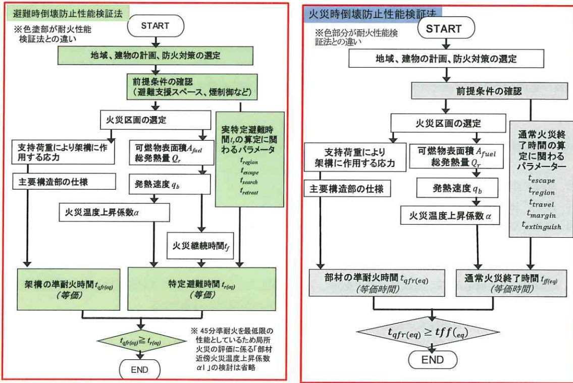
図 6.1.4 主要構造部を避難時・火災時倒壊防止構造とする建築物の検証のフロー図
