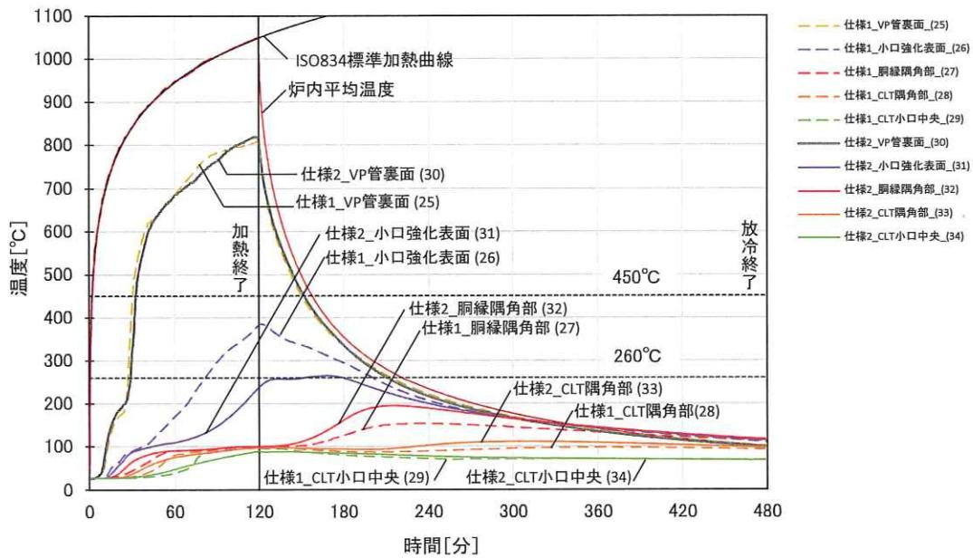
図 1.3.2-4 貫通部(VP 管 100A)の内部温度推移
