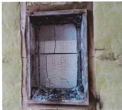
写真 1.3.2-184 加熱面・解体時
