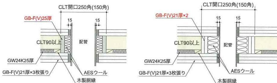
図 1.4-2 2 時間耐火構造壁に対する設備貫通部の防火的な措置の例
