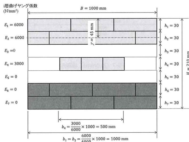
図 4.2.4-3 1 時間燃えしろの残存断面
