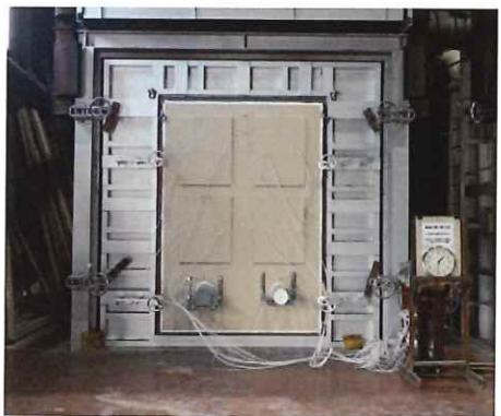
写真 1.3.2-90 非加熱面・加熱開始 90 分後
