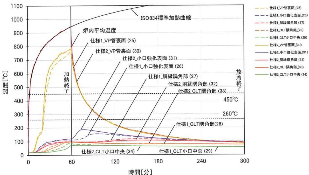
図 1.3.2-18 貫通部 (VP 管 100A) の内部温度推移
