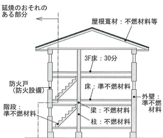
■ 口準耐火建築物 2号（主要構造部不燃構造）
