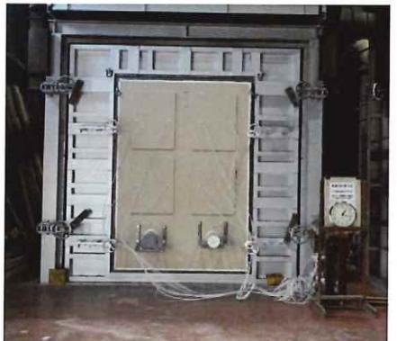
写真 1.3.2-89 非加熱側・加熱開始 75 分後
