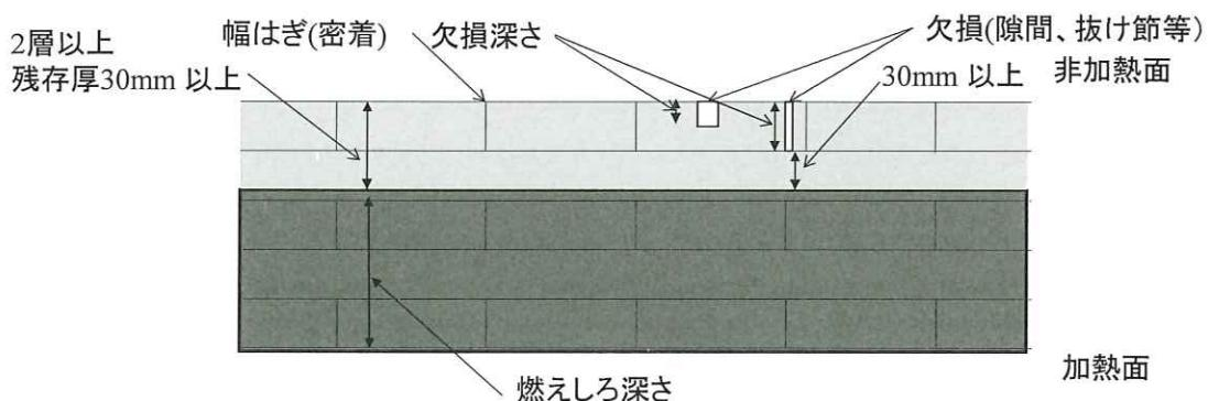
図 6.3.3-2 遮熱性及び遮炎性を有する CLT パネルの燃えしろ深さと残存厚さ
