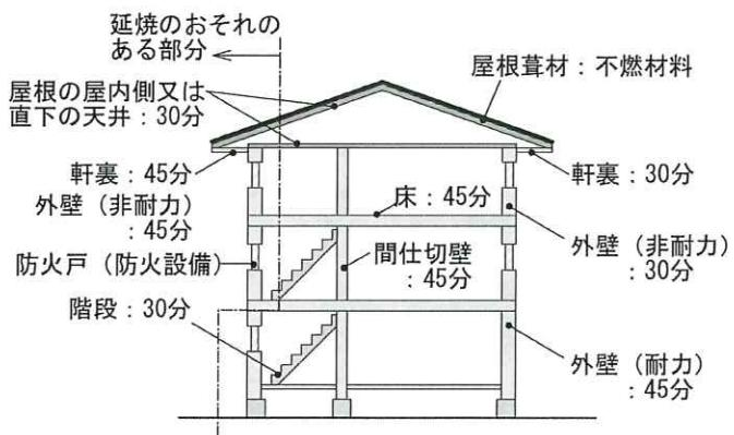
■ イ準耐火建築物（各主要構造部準耐火構造）
