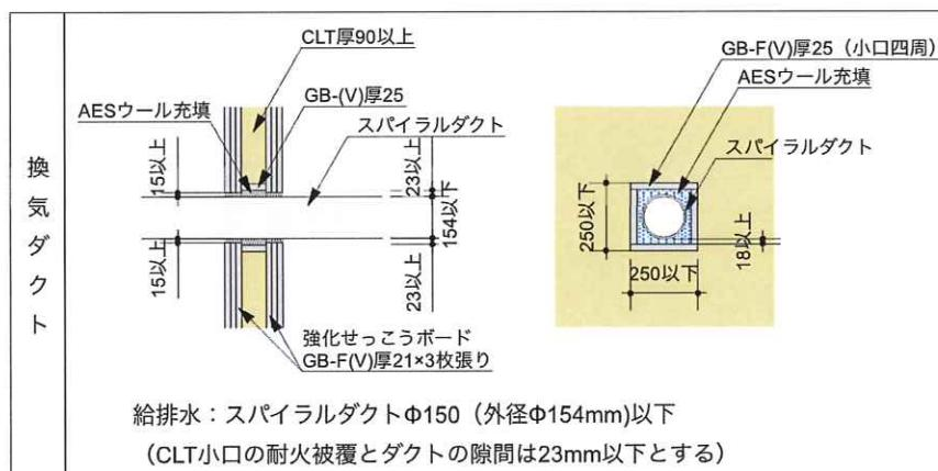
図5.4-2 2時間耐火構造壁の換気ダクトの場合
