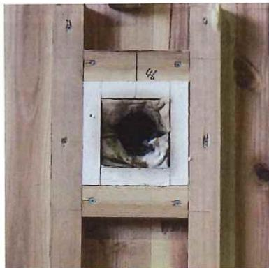
写真 1.3.2-194 加熱面・解体時胴縁表面
