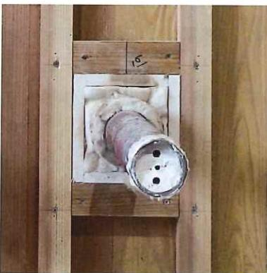
写真 1.3.2-200 加熱面・解体時胴縁表面
