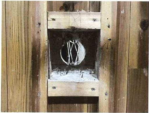
写真 1.3.2-78 加熱面・解体時胴縁表面
