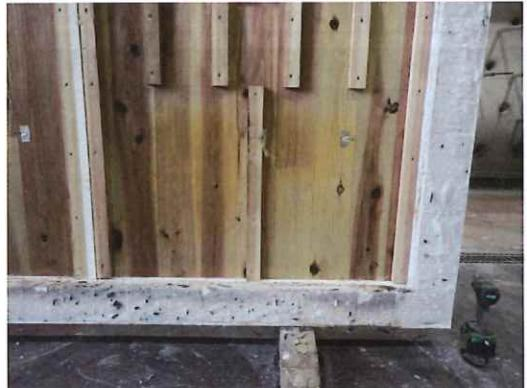
写真 1.3.2-172 加熱面・解体時
