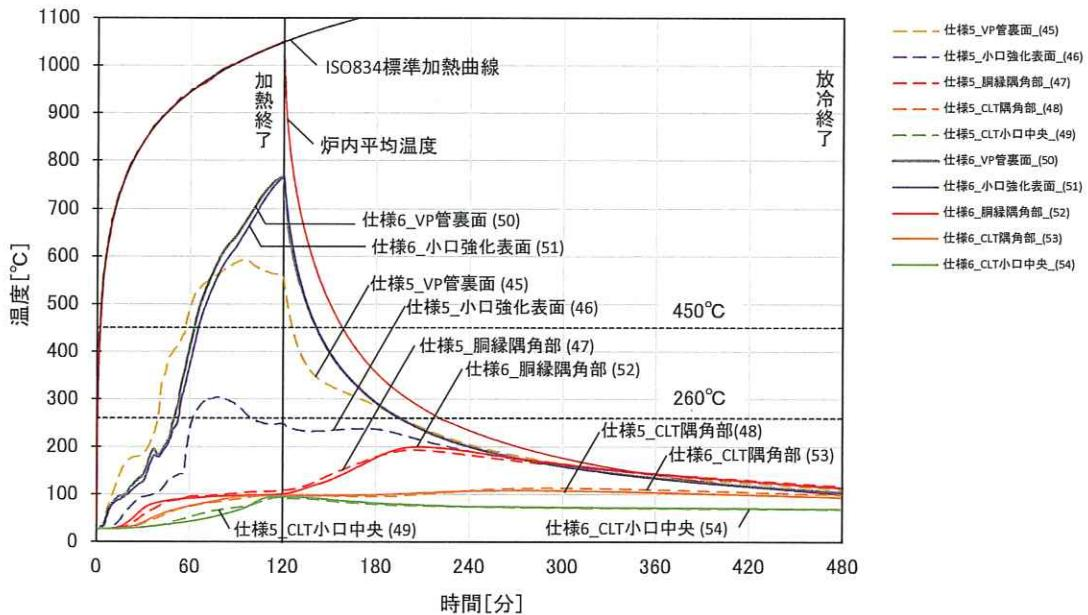
図 1.3.2-6 貫通部(VP 管 50A)の内部温度推移
