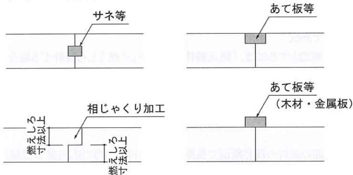
※CLTパネル等の突き付け部は隙間をなくすか塞ぐ。
