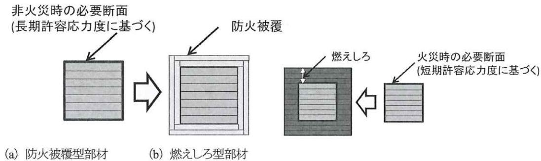
図6.3.1-1 燃えしろ型と防火被覆型部材における必要断面の概念
