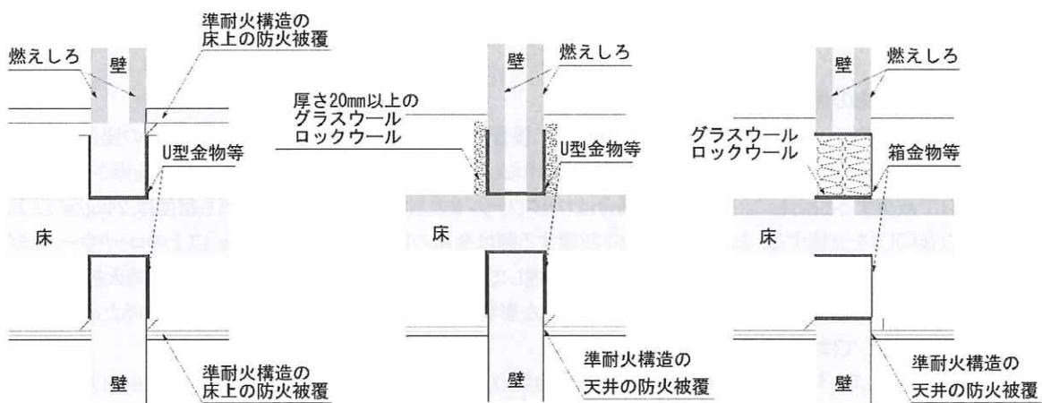
図 4.2.5-7 防火被覆の内側に配置される接合金物
