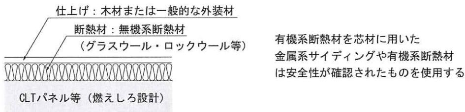
図 6.3.7-1 断熱材+仕上げ材の例
