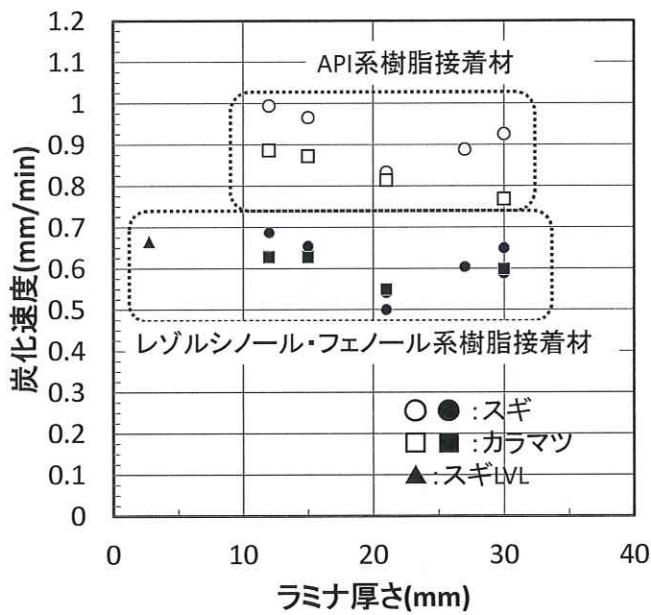
図 4.2.1-3 CLT パネルの炭化速度
