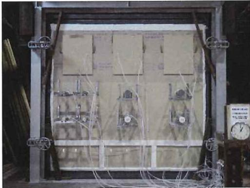
写真 1.3.2-143 非加熱面・加熱開始 60 分後
