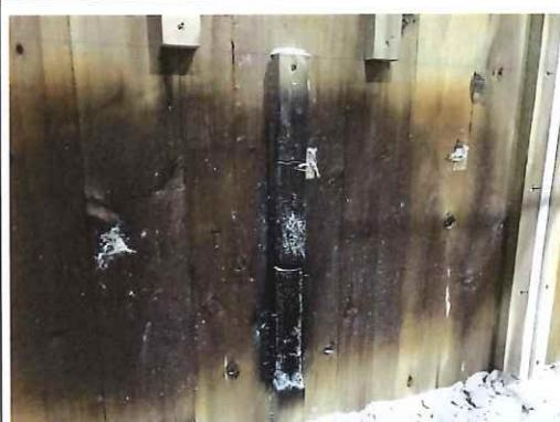
写真 1.3.2-54 加熱面・解体時
