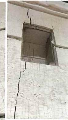
写真 1.3.2-57 加熱面・脱炉直後
