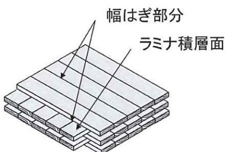
図 4.2.1-5 CLT パネルの接着 (積層面、幅はぎ)
