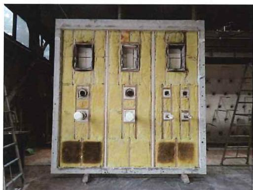
写真 1.3.2-169 加熱面・解体時
