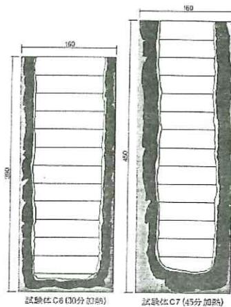
図 4.2.1-1 集成材の炭化状況（加熱時間 左:30 分、右:45 分）
