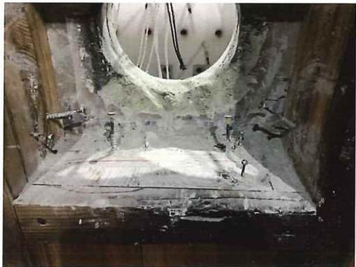
写真 1.3.2-67 加熱面・解体時 CLT 表面
