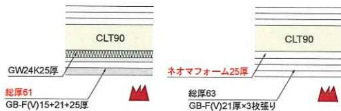
図1.5 本事業の実験から示された耐火構造の壁の耐火被覆仕様
