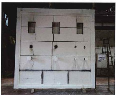
写真 1.3.2-167 加熱面・脱炉直後
