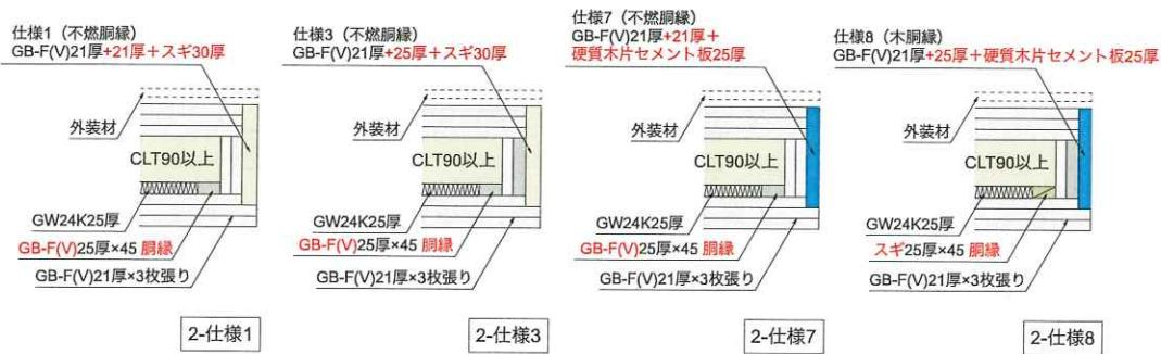
図 1.4-1 2 時間耐火構造壁に対する開口部小口の防火的な措置の例
