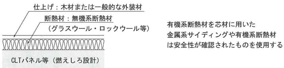
図 4.2.6-1 断熱材+仕上げ材の例
