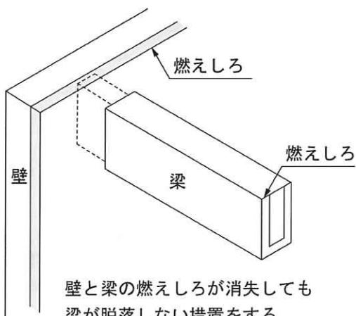
図 4.2.5-5 梁の脱落防止の措置（例）
