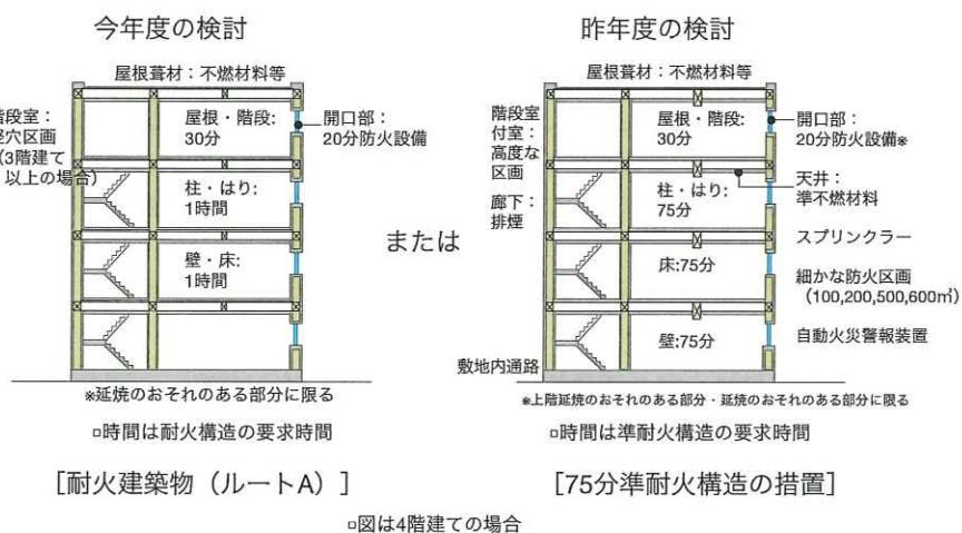
図1.1 4階建て建物を設計するための耐火建築物と75分準耐火構造の建築物の違い
