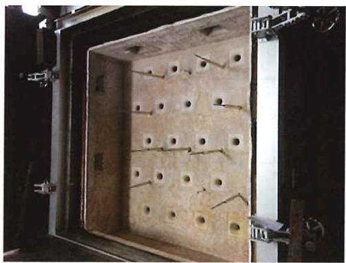
写真 1.3.1-7 日本住宅・木材技術センター壁炉（非載荷）
