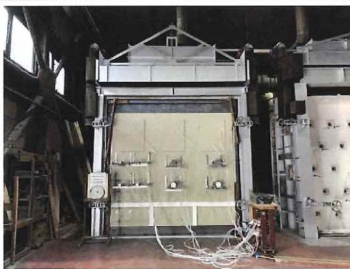
写真 1.3.2-8 非加熱側・加熱開始 75 分後
