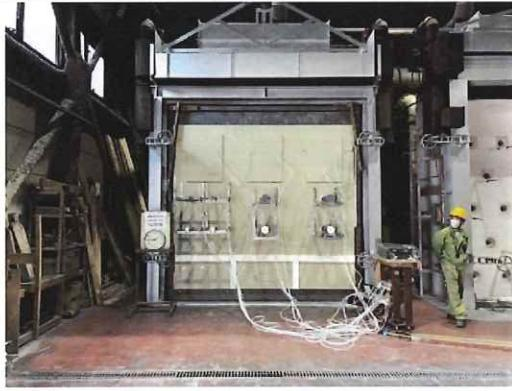
写真 1.3.2-10 非加熱面・加熱開始 105 分後
