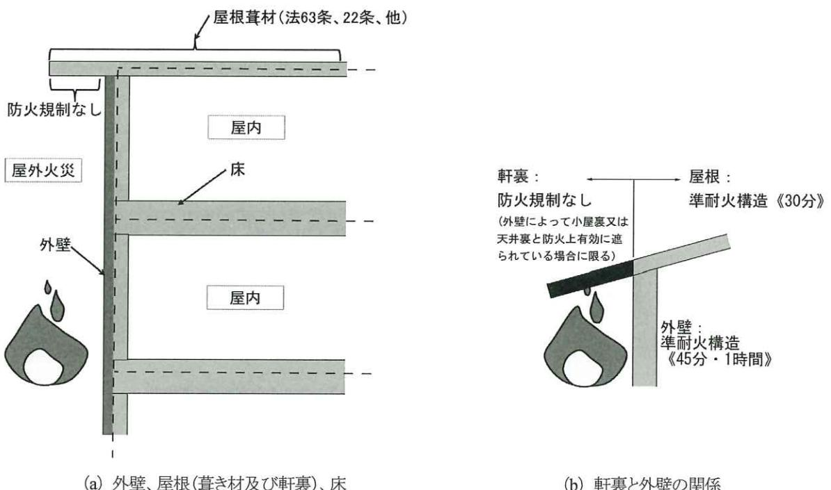
図 4.2.2-6 屋外火災における防火区画内の燃えしろ想定面（断面図）
