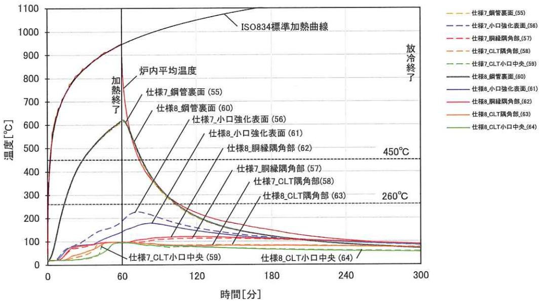
図 1.3.2-21 貫通部(鋼管 50A)の内部温度推移
