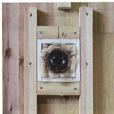
写真 1.3.2-196 加熱面・解体時胴縁表面
