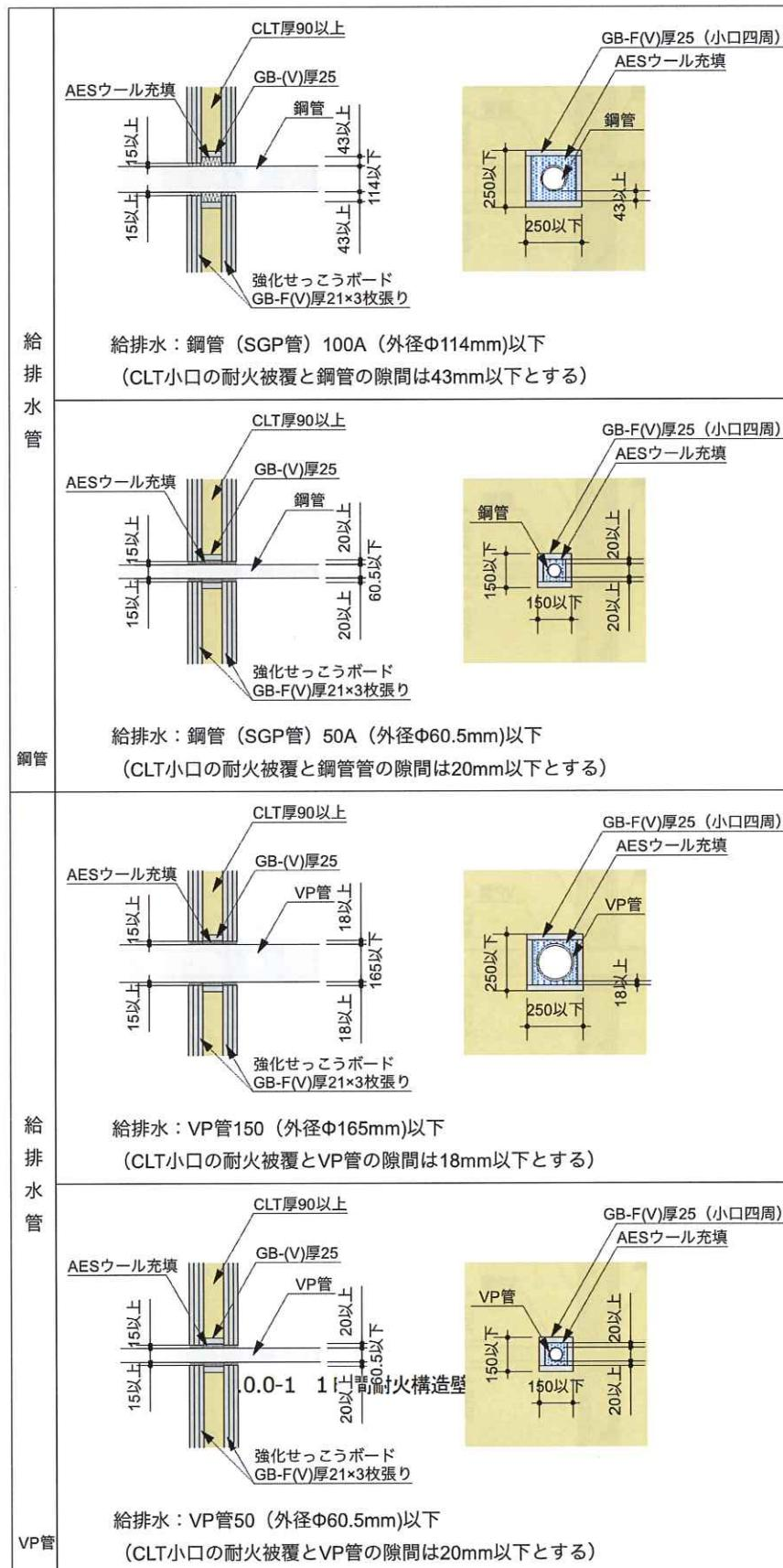
図 5.4-4 2 時間耐火構造壁の給排水管の場合
