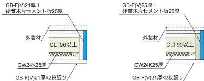
図 5.4-5 1 時間耐火構造壁のサッシ・扉等開口部の防火措置
