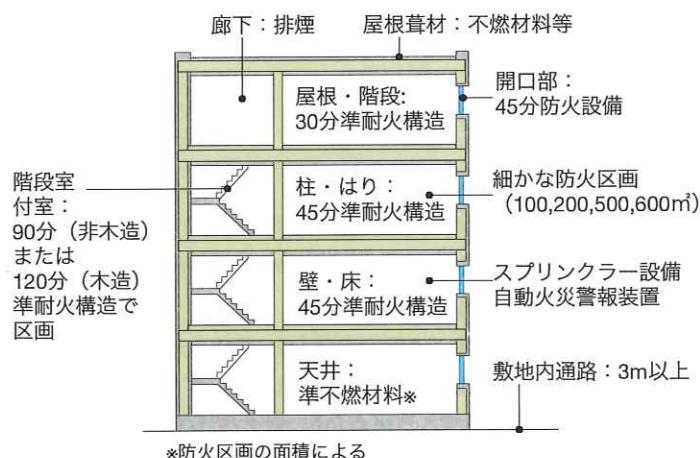
上図①②は延べ面積1000m<sup>2</sup>程度の場合について、告示の検証法により主要構造部の準耐火構造と開口部の要求性能等を計算した一例です
