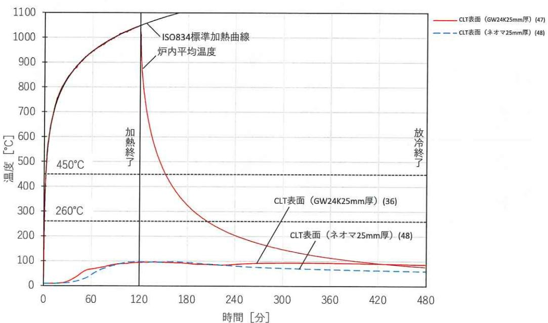
図 1.3.2-14 一般部の内部温度推移
