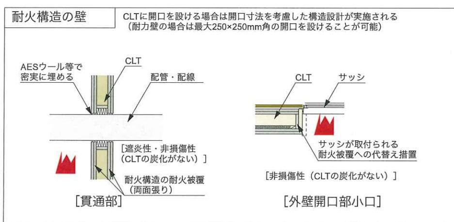
図 1.2 耐火構造の壁の設備貫通部・被覆材代替え部に求められる防耐火性能の例
