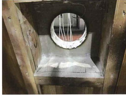
写真 1.3.2-73 加熱面・解体時 CLT 表面
