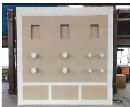
加熱面側の施工状況（全景）
