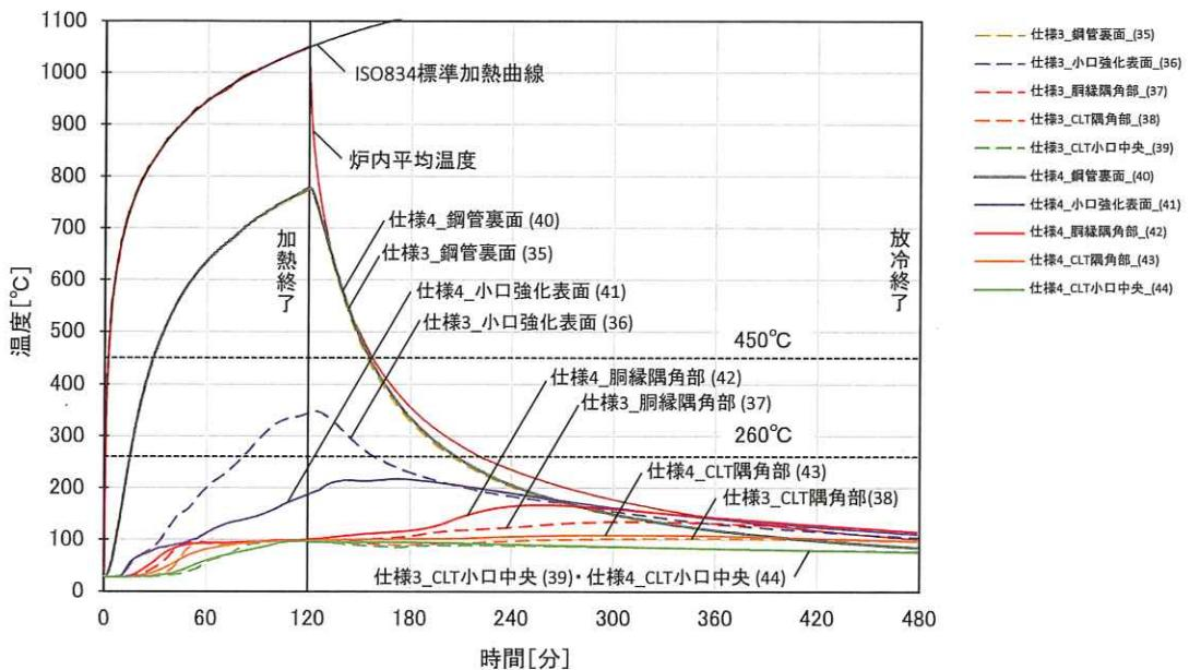
図 1.3.2-5 貫通部(鋼管 100A)の内部温度推移
