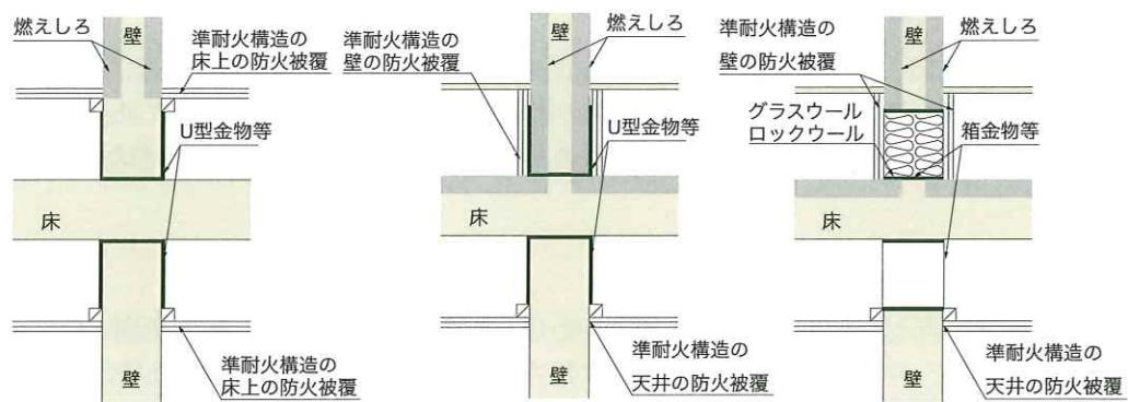
図 6.3.5-2 防火被覆の内側に配置される接合金物
