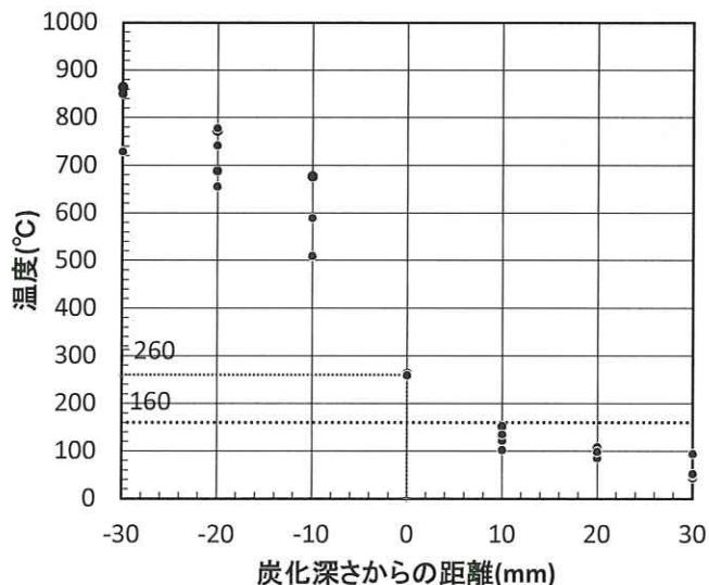
図 6.3.3-1 木質部材の炭化深さからの距離と部材温度(スギ集成材)
