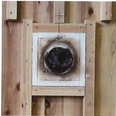
写真 1.3.2-188 加熱面・解体時胴縁表面
