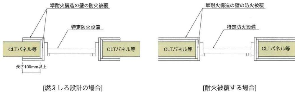
図 6.3.6-3 サッシ・扉等開口部の防火措置
