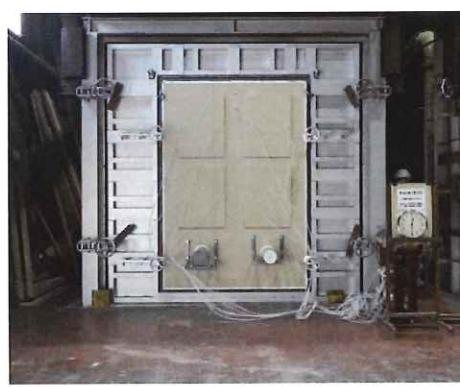
写真 1.3.2-86 非加熱面・加熱開始 30 分後
