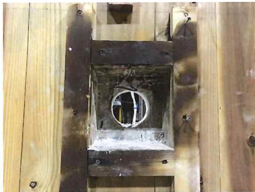
写真 1.3.2-74 加熱面・解体時胴縁表面
