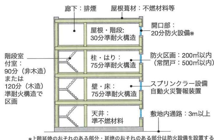
図 3.1.2-1 防火・準防火地域以外の 4 階建て事務所の場合(仕様規定で設計する場合)
