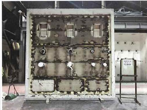
写真 1.3.2-52 加熱面・解体時
