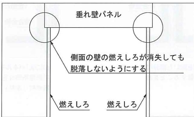
図 4.2.5-4 垂れ壁パネルの脱落防止の措置（例）
