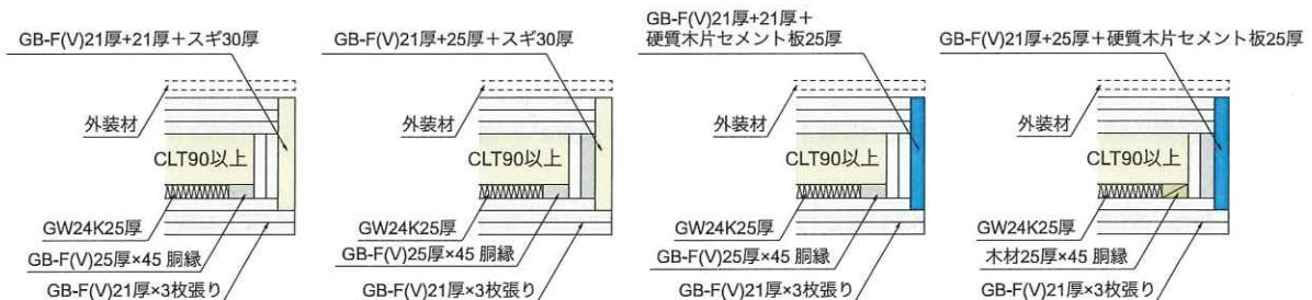
図 5.4-6 2 時間耐火構造壁のサッシ・扉等開口部の防火措置
