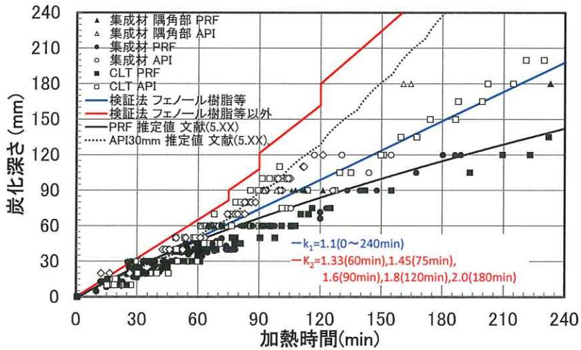
図 6.3.1-3 長時間加熱を受ける木質構造部材(スギ集成材、スギ CLT パネル)の炭化深さ
