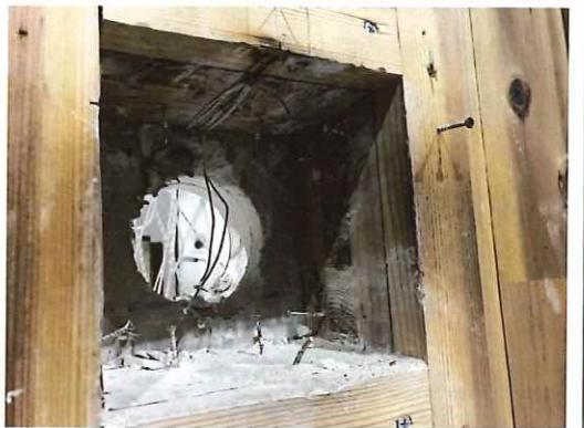
写真 1.3.2-79 加熱面・解体時 CLT 表面
