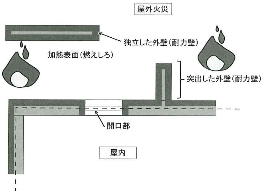
図 4.2.2-5 屋外火災における防火区画内の燃えしろ想定面（平面図）
