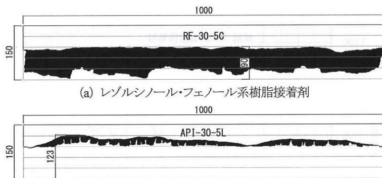
図 4.2.1-4 CLT パネルの炭化図
