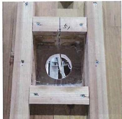
写真 1.3.2-197 加熱面・解体時 CLT 表面
