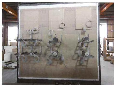
非加熱面側の施工状況（全景）
