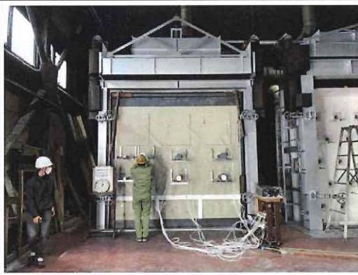
写真 1.3.2-7 非加熱側・加熱開始 60 分後
