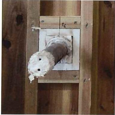
写真 1.3.2-198 加熱面・解体時胴縁表面
