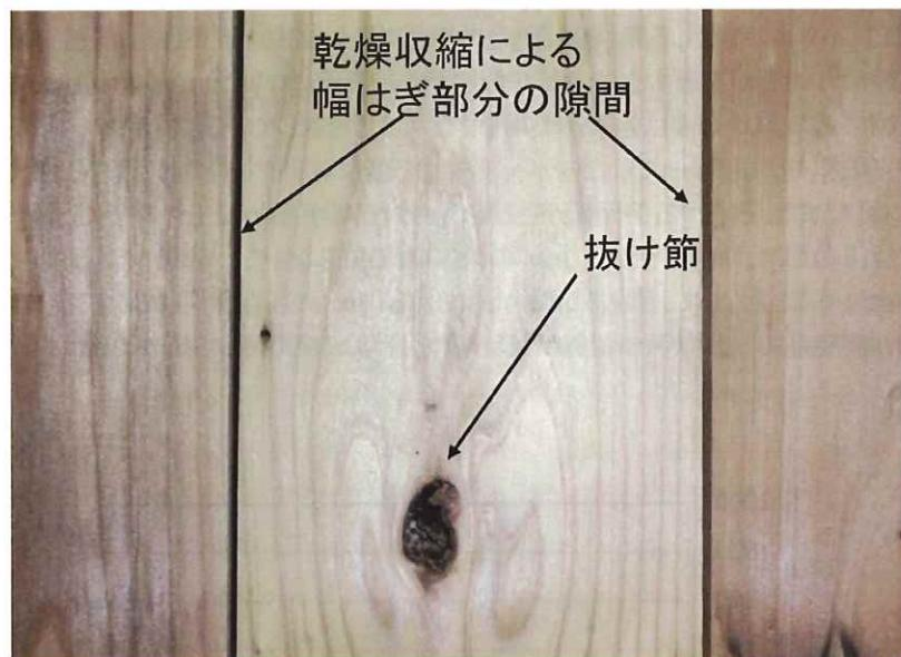
図 6.3.3-3 残存厚さと見なせない部分の一例(CLT パネル)
