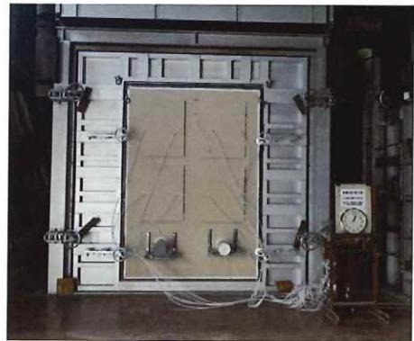
写真 1.3.2-88 非加熱側・加熱開始 60 分後
