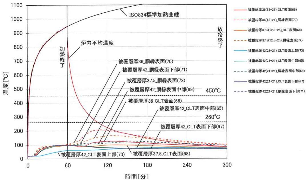
図 1.3.2-22 一般部の内部温度推移
