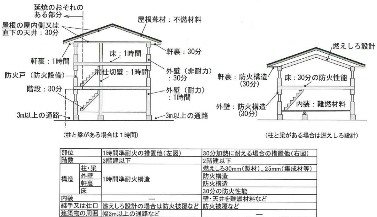
図 3.1.2-2 主要構造部を木造とすることができる大規模の建築物
