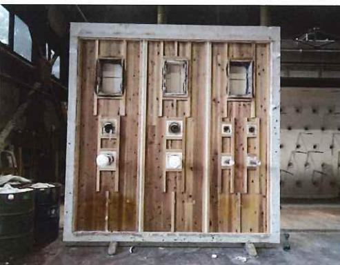
写真 1.3.2-170 加熱面・解体時
