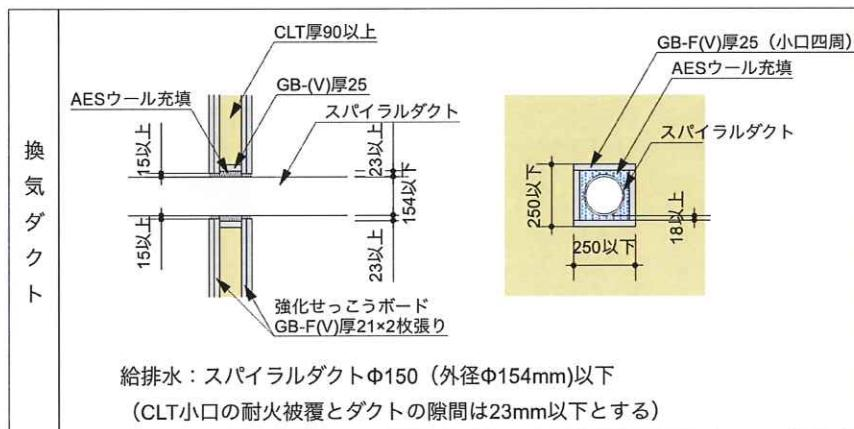
図5.4-1 1時間耐火構造壁の換気ダクトの場合
