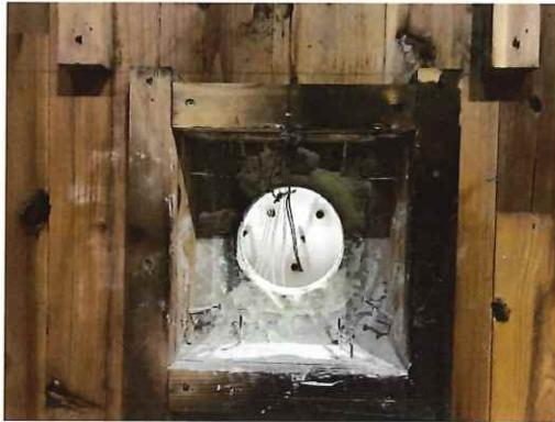
写真 1.3.2-66 加熱面・解体時胴縁表面
