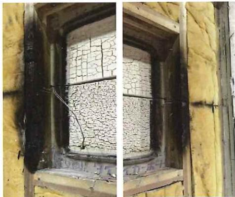
写真 1.3.2-65 加熱面・解体時 CLT 表面
