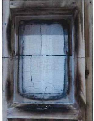
写真 1.3.2-181 加熱面・解体時 CLT 表面
