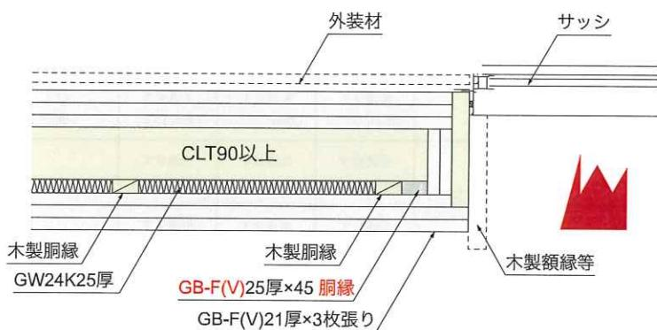
図 1.3.3-1 2 時間耐火構造壁の開口部小口の代替措置の検討実験結果
