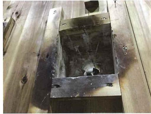
写真 1.3.2-77 加熱面・解体時 CLT 表面
