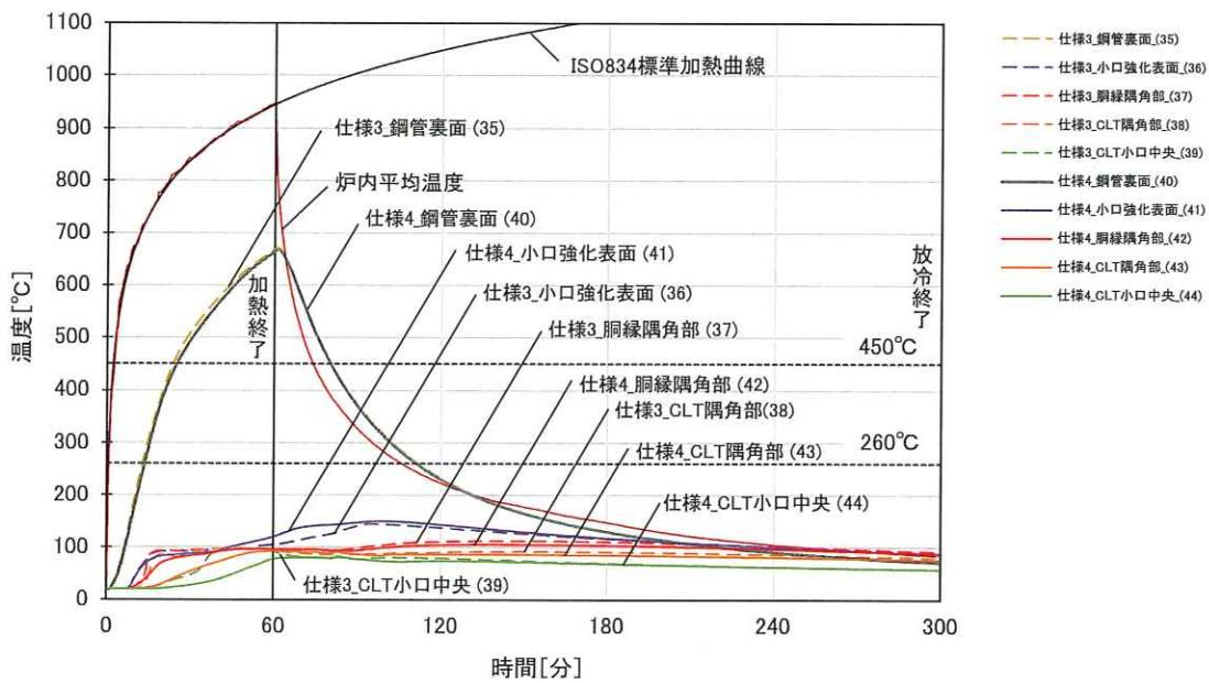
図 1.3.2-19 貫通部(鋼管 100A)の内部温度推移
