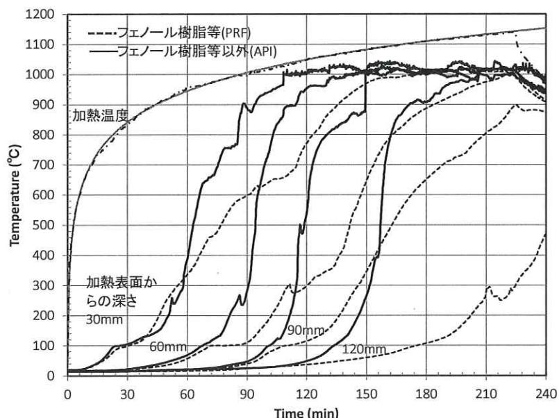
図 6.3.1-2 異なる接着材を用いた CLT パネルの内部温度
