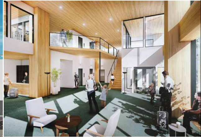
【エントランスホール】 壁、床を防火区画することで中間床を木造化しています。
