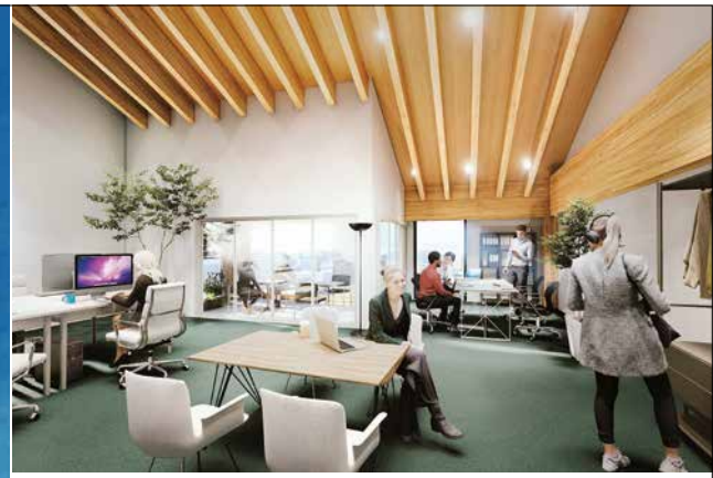
【最上階の coworking スペース】 壁、床を防火区画することで最上階の屋根を木造化しています。
