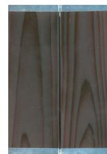
半造膜形塗料を塗布した木材の仕上げ面
