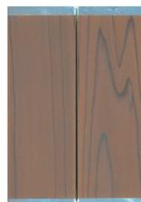
含浸形塗料を塗布した木材の仕上げ面
