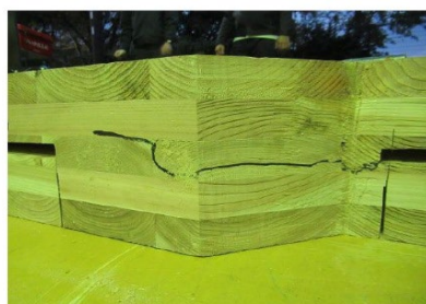
写真6.3 代表的な破壊性状③ (No. 3)
