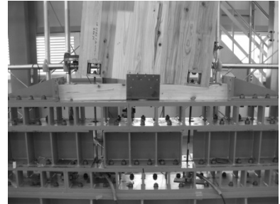
写真 1-3 LSB 接合と鋼板添え 板ビス接合の例
