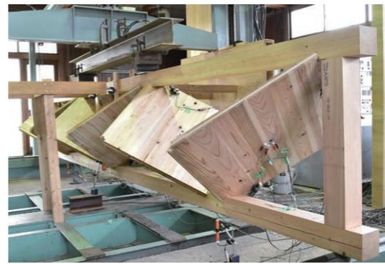
CLT平行弦トラスは、3等分点4点曲げ試験を2体行っています。最大荷重は42.5kNでした。破壊したビス接合部においてCLT内層の面内方向に割れが生じ、原因としては接合部の微小回転が関係していることが考えられます。
