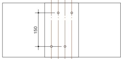
CLT間接手方向・幅はぎ方向接合部
