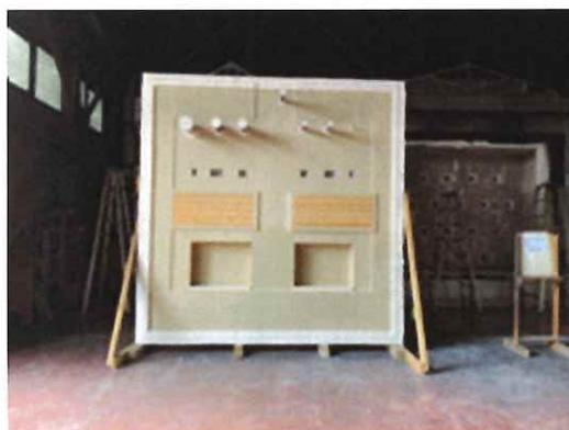
写真1 試験体1（壁）の加熱面の様子
