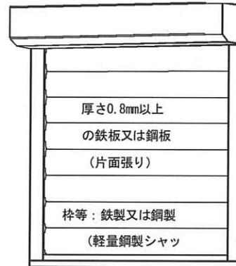
図2.5.2-2 鉄製又は鋼製軽量シャッター例
