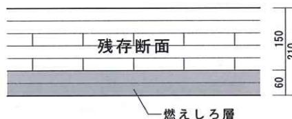
図3.3-4 CLT床版の残存断面
