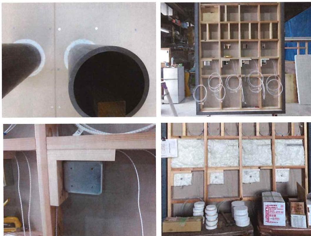
写真 4 試験体の各部の様子 (左上：配管と被覆材の取合い部、右上：下地全景
