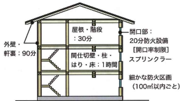
図1.3.2-4 延べ面積3,000㎡以下の共同住宅等の各部の要求性能
