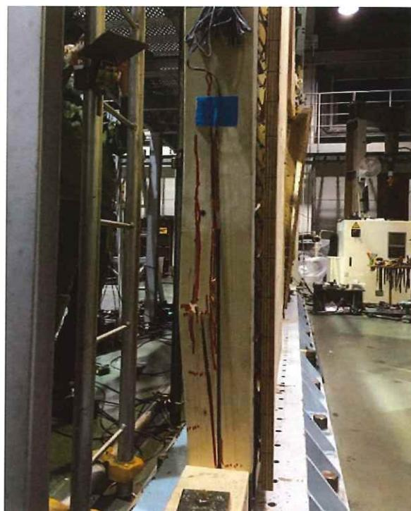
左側耐力壁の圧縮側柱脚部(柱割裂)
