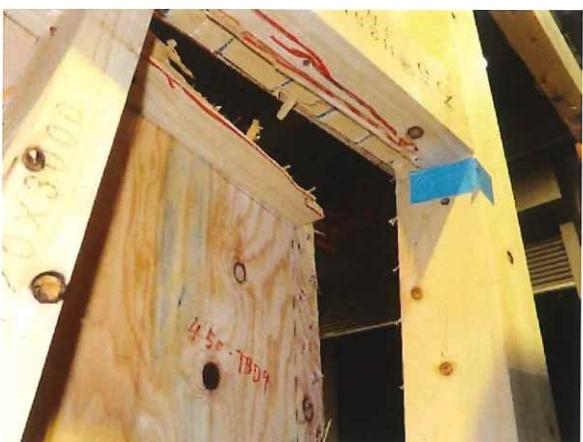
右側耐力壁合板継ぎ目(中棟割裂破壊)
