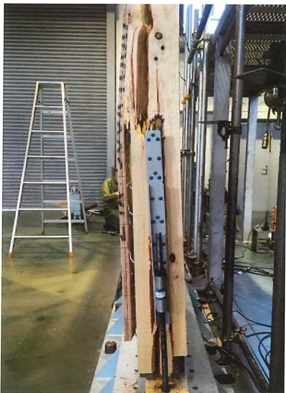
右側耐力壁引張側柱脚部(HD 上部での破断)
