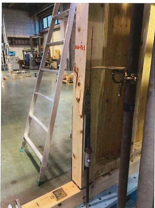
HD 接合部付近の柱の曲げ引張破壊(裏)
