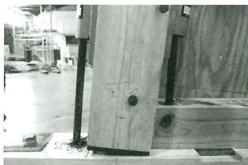
写真 2.1-2 アンカーボルトの降伏による柱脚の引張破壊(浮き上がり)
