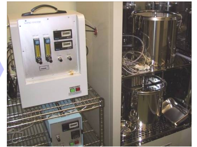
②試験片を置いたチャンバー内に 湿度・流量が一定の空気を流す
