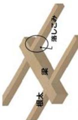
図 4.3.27 床梁と根太の納まり
