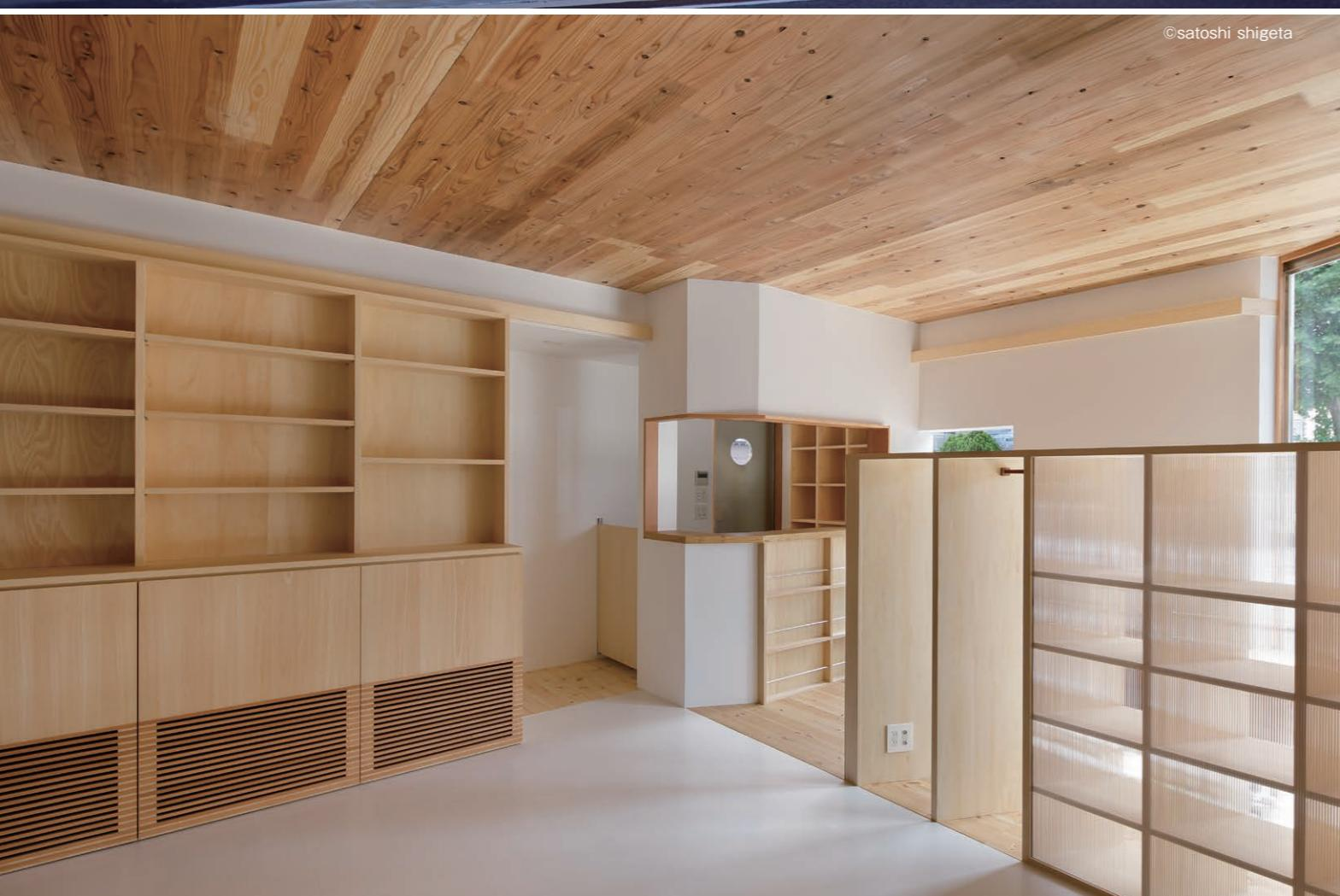
CLTを2階の床構面に採用した2階建て木造軸組構法の併用住宅です。本建築は比較的狭小な敷地に建設され、1階部分が店舗、2階部分が住宅となっています。1階の店舗を無柱空間としつつ、外部駐車面積を確保しながら、2階居住部分の床面積を確保するため、2階床構面にCLTを用いることではね出しを実現することができました。日本の都市型住居における1つのCLT有効利用の典型例といえます。
