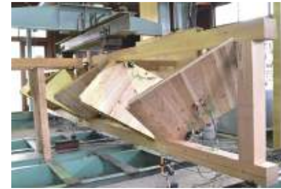
CLT平行弦トラスは、3等分点4点曲げ試験を2体行っています。最大荷重は42.5kNでした。破壊したビス接合部においてCLT内層の面内方向に割れが生じ、原因としては接合部の微小回転が関係していると考えられます。
