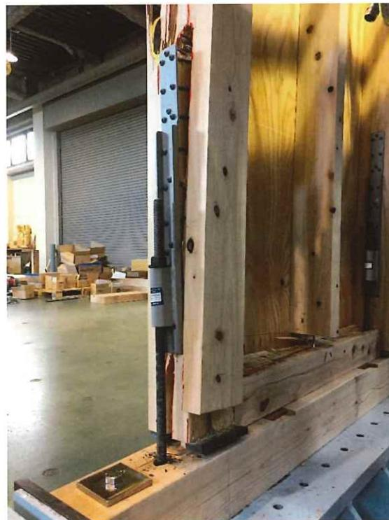
右側耐力壁引張側柱脚のHD接合部
