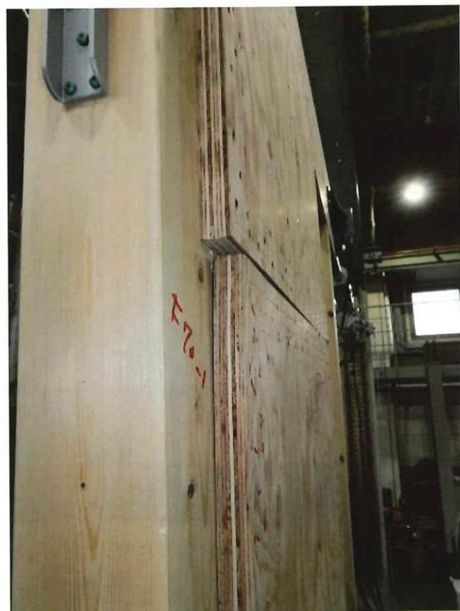
写真 【F70-1】 合板の浮きと釘頭のめり込み(加力終了時)
