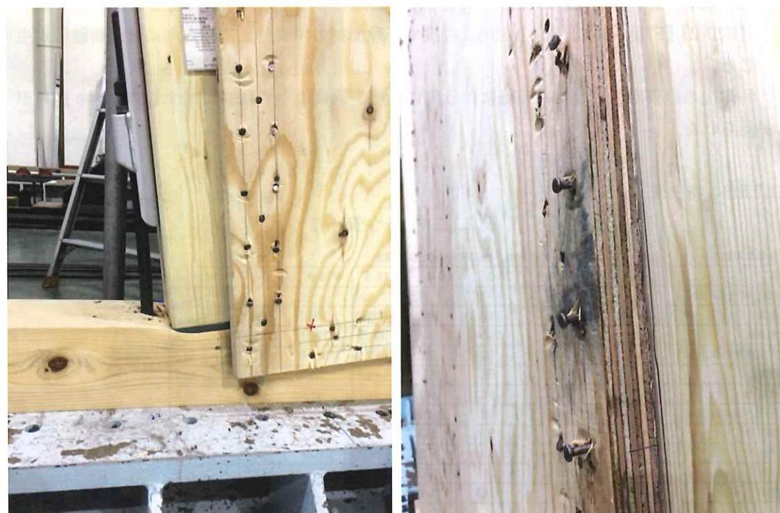
写真 【70-1】 柱の土台へのめり込み
