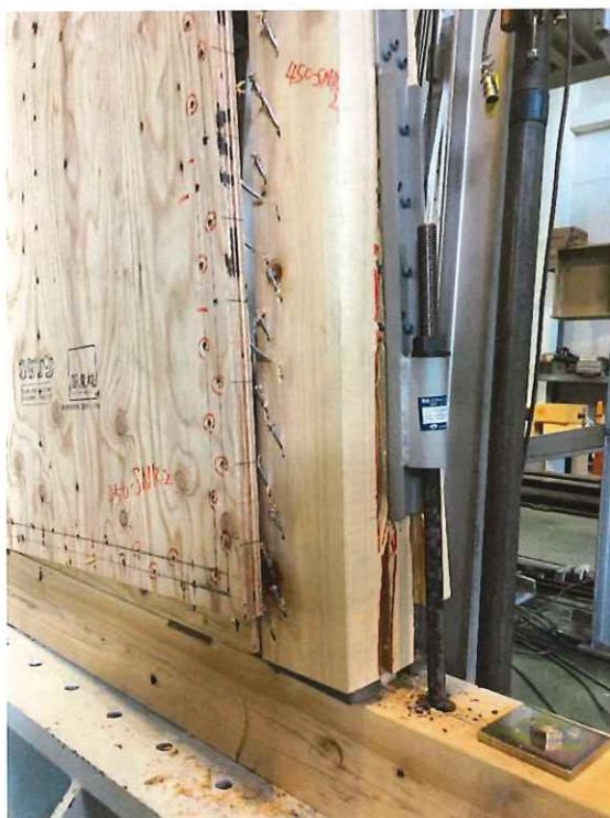
右側耐力壁引張側柱脚部
