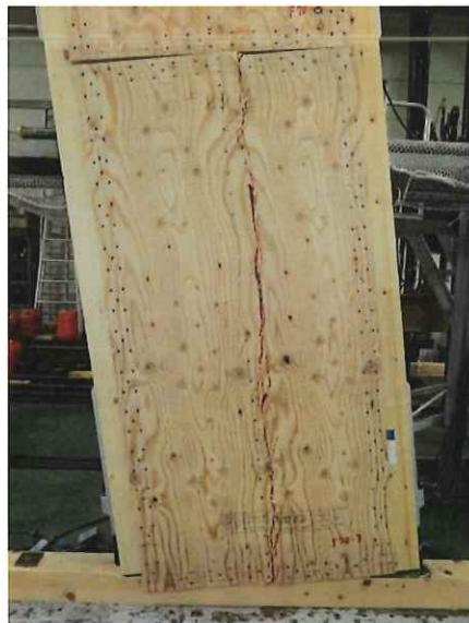
写真【F70-3】合板のせん断破壊
