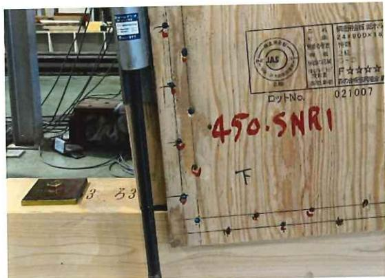
右側耐力壁の圧縮柱脚部
