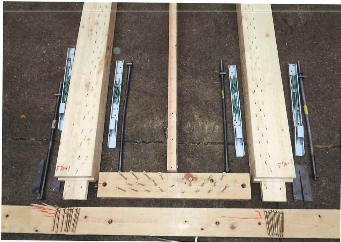
写真 【F70-1】解体時 柱脚付近 釘の変形に伴う木材へのめり込み
