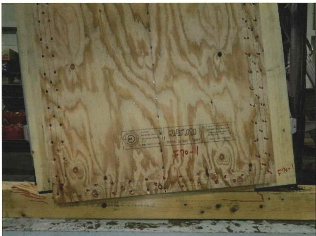
写真 【F70-1】 柱の土台へのめり込みとアンカーボルトの伸び(加力終了時)
