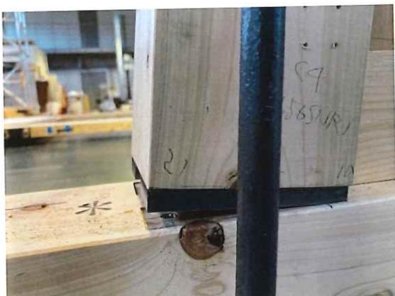
右側耐力壁の引張柱脚部
