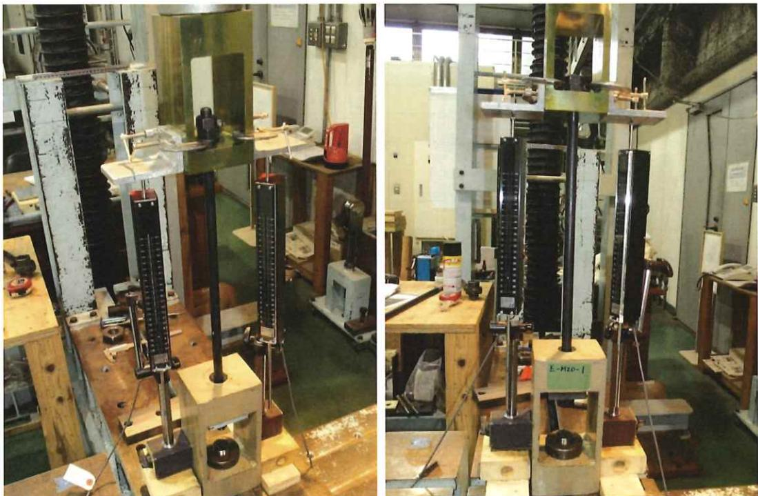
写真 ボルト引張試験状況
