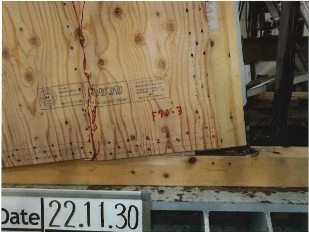
写真 【F70-3】 アンカーボルトの伸びと合板のせん断破壊(加力終了時)
