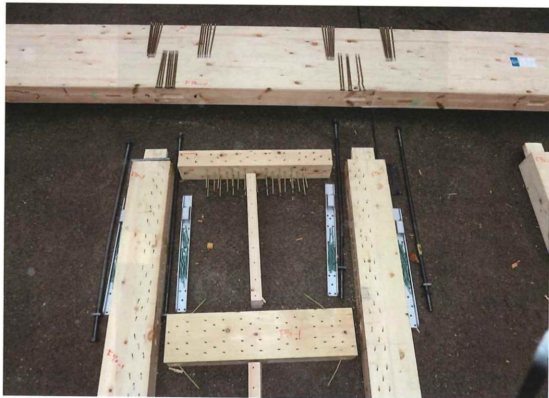
写真 【F70-1】解体時 柱頭付近 釘の変形に伴う木材へのめり込み
