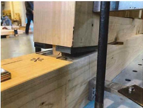
右側耐力壁の引張側柱脚部
