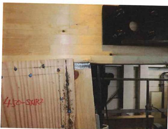
右側耐力壁の圧縮側柱頭部
