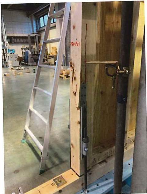
HD 接合部付近の柱の曲げ引張破壊(裏)
