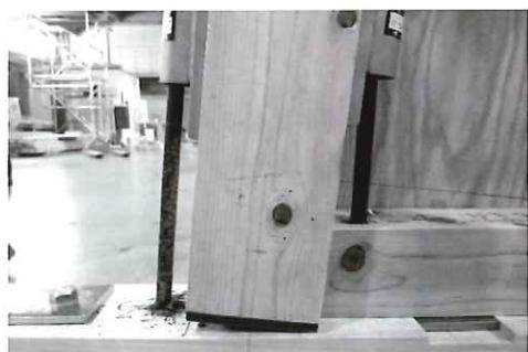
写真 2.3-2 アンカーボルトの降伏による柱脚の引張破壊(浮き上がり)
