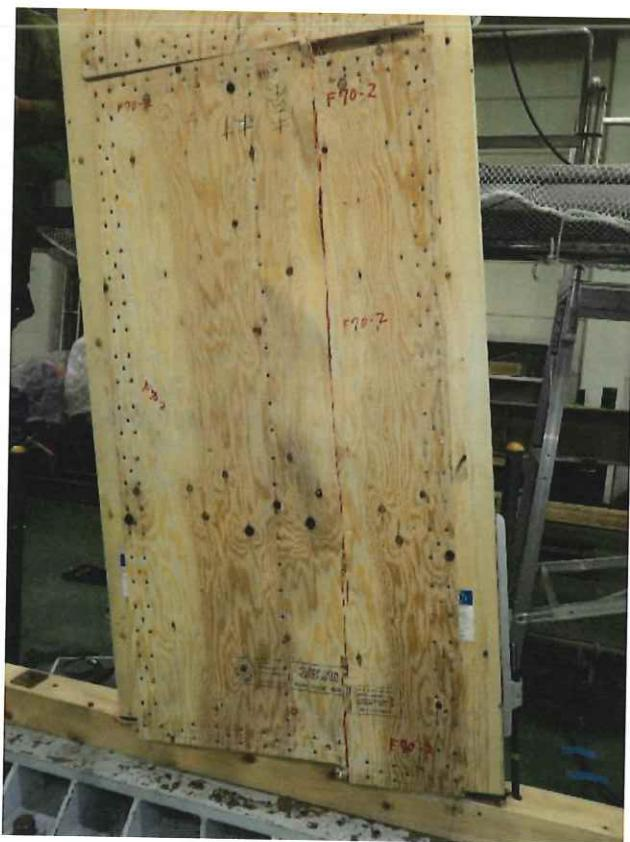
写真 【F70-2】合板のせん断破壊(加力終了時)
