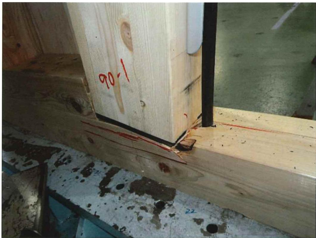
写真 【90-1】柱の土台へのめり込み(加力終了時)
