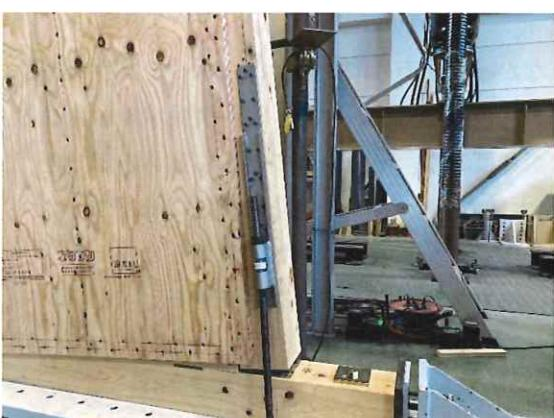
右側耐力壁の引張側柱脚部
