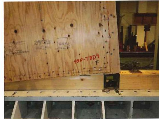
右側耐力壁の圧縮側柱脚部
