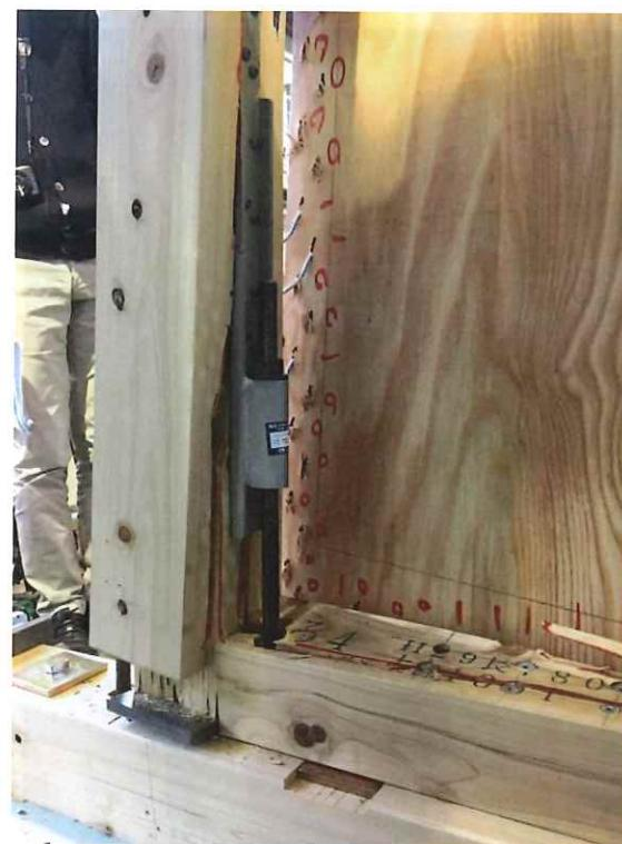
右側耐力壁引張側柱脚部(面材側 HD)
