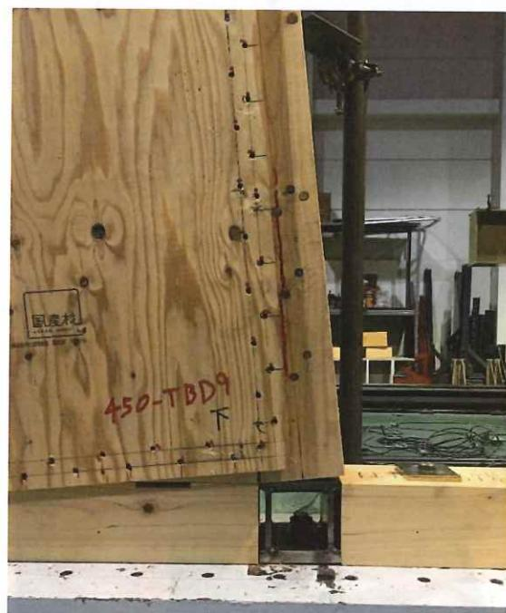
右側耐力壁の引張側柱脚部
