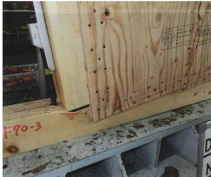
写真 【F70-3】柱の土台へのめり込み(加力終了時)
