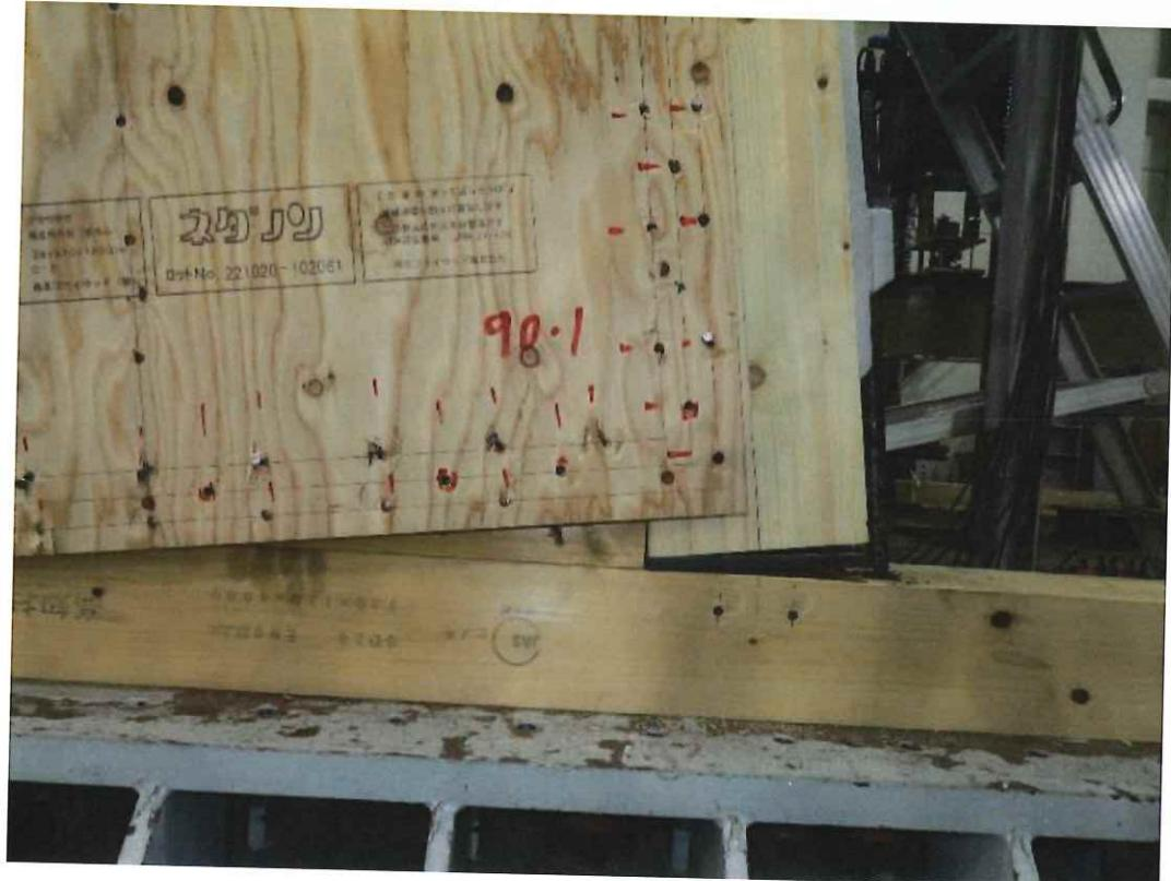
写真 【90-1】 アンカーボルトの伸び・降伏(加力終了時)
