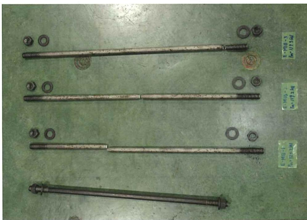
写真 ボルト引張試験終了時
