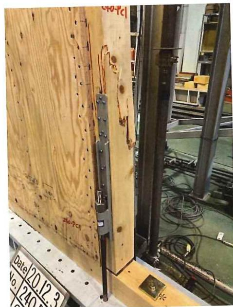
HD 接合部付近の柱の曲げ引張破壊(表)
