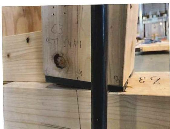
右側耐力壁の圧縮柱脚部
