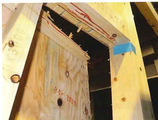
右側耐力壁合板継ぎ目(中棧割裂破壊)
