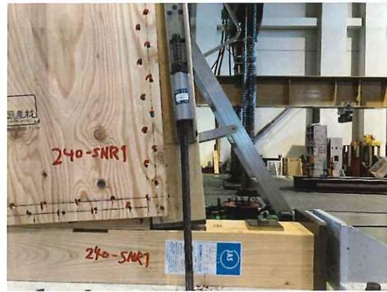
右側耐力壁の引張側柱脚部
