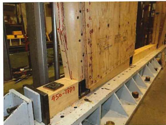
左側耐力壁の圧縮側柱脚部
