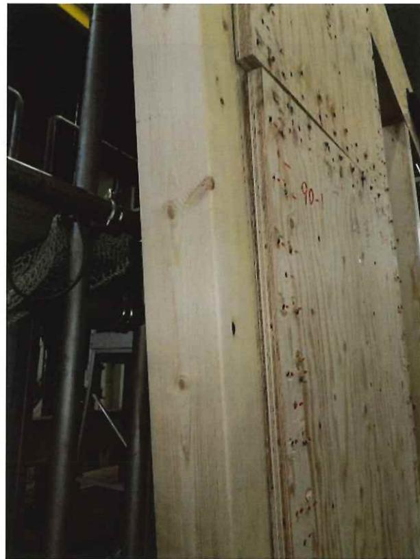
写真 【90-1】釘の抜け出し、釘頭のめり込みと合板の浮き(加力終了時)
