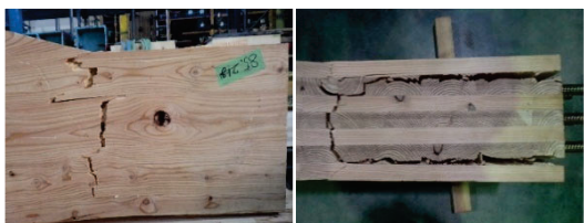
写真 3.1.1 試験 I GCT-I (カラマツ) の破壊性状
