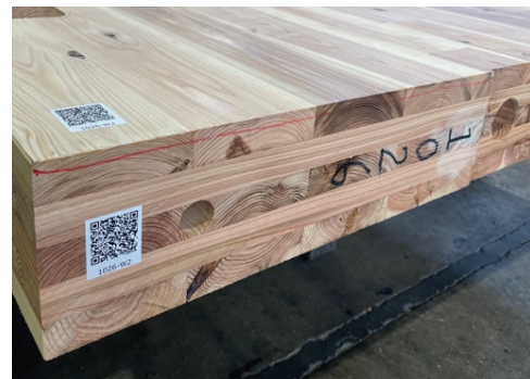
写真) 発行した QR コードを防水性のあるラベルシールにプリントしそれらを CLT 加工工場において貼りつけている様子
