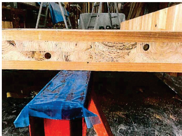
写真 3-1 偏芯させたダボ配置
