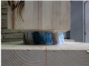
写真 3.2.1 実験終了時の試験体の上部の壁材のねじれ及び被覆材位置でのコネクタの様子
