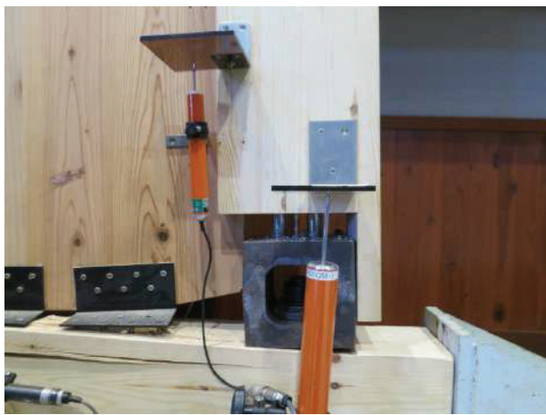
図 11 右側タフネスコネクタ引抜破壊の様子 (UCLT-01)
