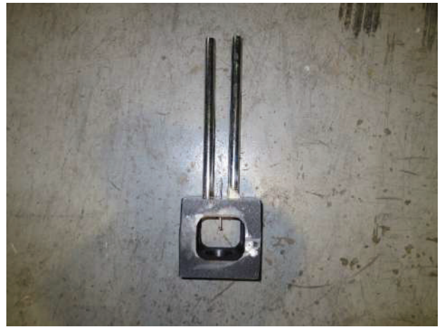
図 16 右側タフネスコネクタの破断の様子 (UCLT-02)
