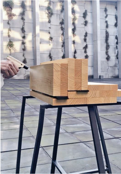
写真 1.2-2 モックアップによる止水性の検証
