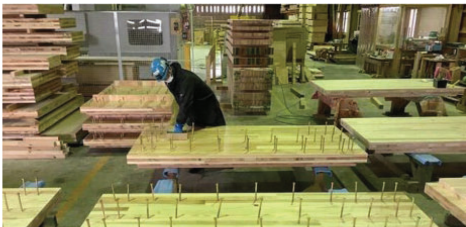
図 8-5-1-3. CLT パネル ラグスクリューボルト打込状況
