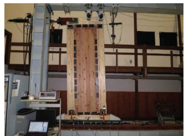
図 18 最大変形時の試験体全景 (UCLT-03)
