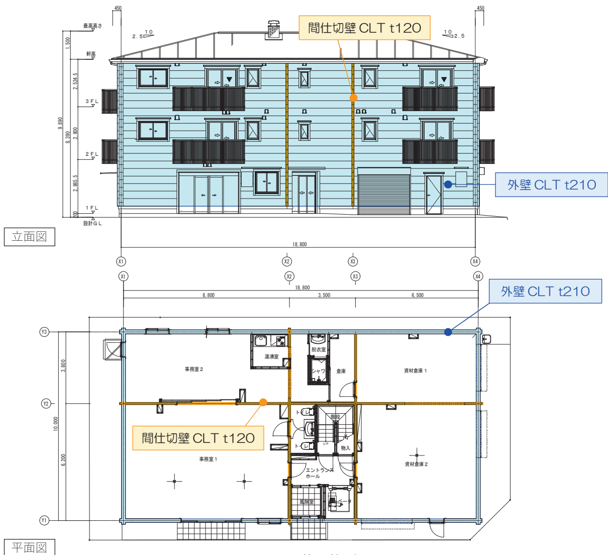
図 2-5 CLT 使用箇所
