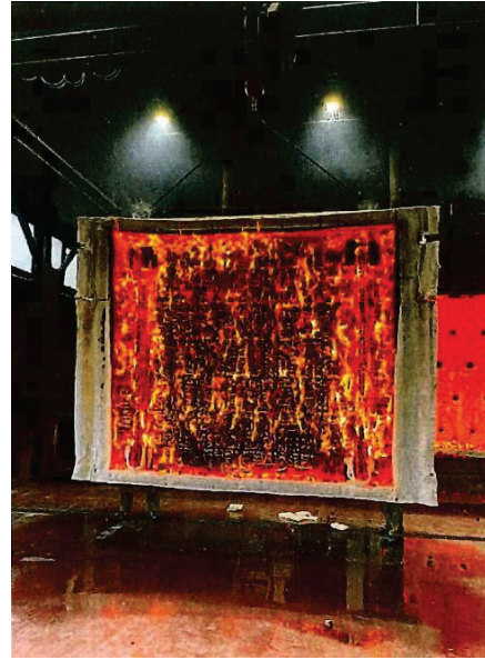
写真 3-8 試験終了時の加熱面の様子
