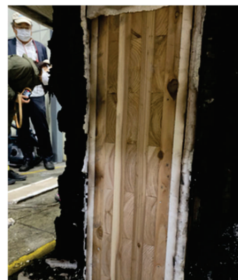
写真 4.4.2 主要構造部の表面（炭化なし）
