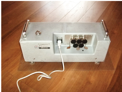
写-1 標準軽量衝撃源 (タッピングマシン)
