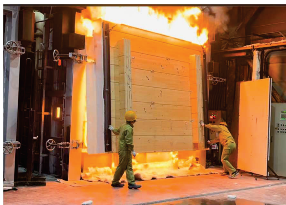
写真 3-16 燃焼試験後に試験台から取り外した瞬間
