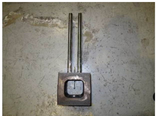
図 20 右側タフネスコネクタの破断の様子 (UCLT-03)
