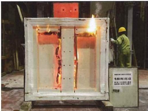
写真 15-3 加熱面・加熱 110 分後
