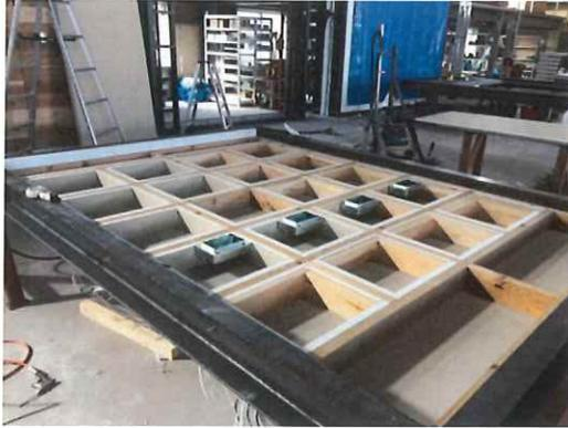
大型壁（試験体 1）の壁内の施工状況
