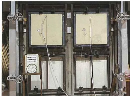
写真 9-10 非加熱面・実験開始 90 分後
