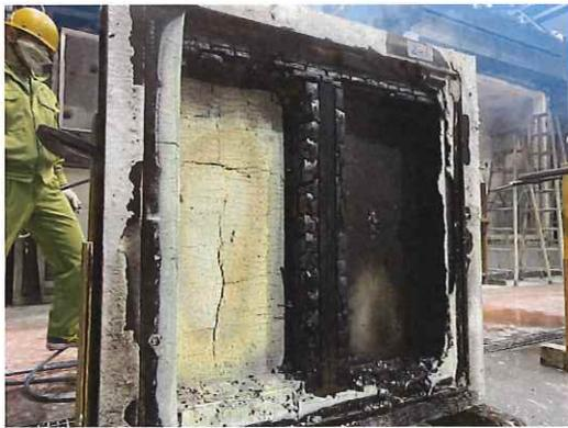
写真 9-15 構造躯体・解体時（試験体 2-1）
