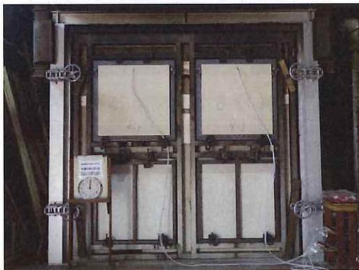
写真 13-5 非加熱面・実験開始時
