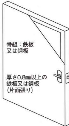
図2.9.2-1 鉄製又は鋼製ドア例
