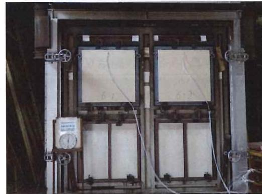
写真 17-6 非加熱面・実験開始 30 分後
