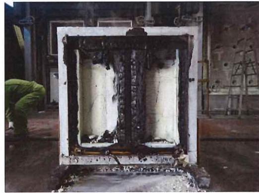
写真 13-14 加熱面・解体時（試験体 4-2）
