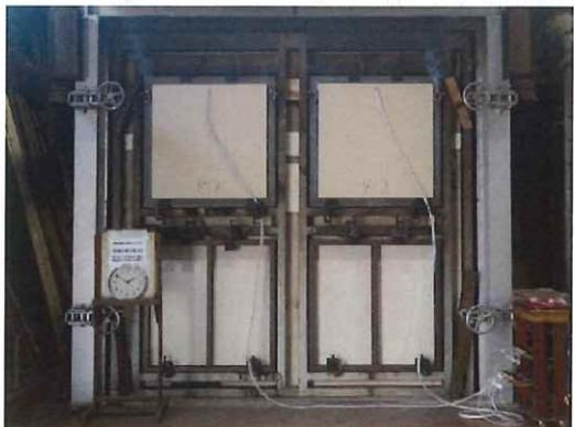
写真 13-12 非加熱面・実験開始 110 分後
