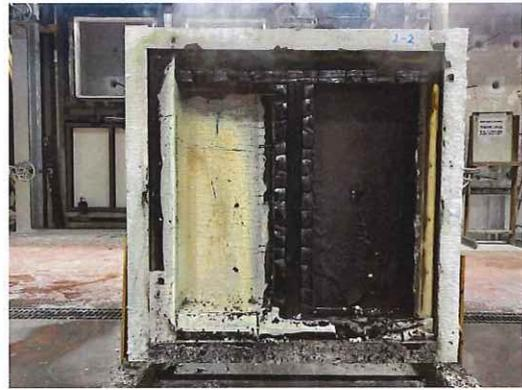
写真 9-14 加熱面・解体時（試験体 2-2）
