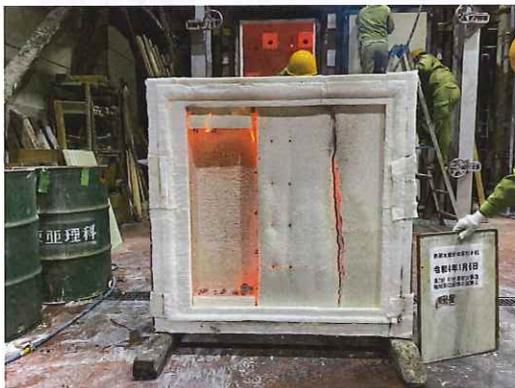
写真 9-3 加熱面・加熱 110 分後
