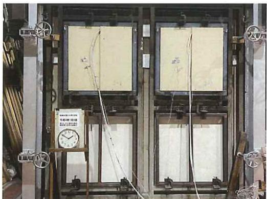
写真 9-12 非加熱面・実験開始 110 分後
