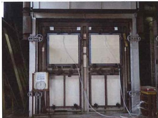
写真 17-5 非加熱面・実験開始時
