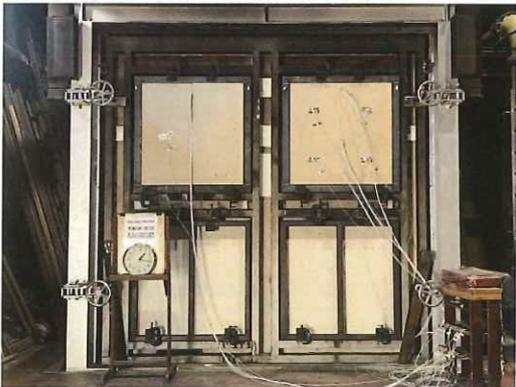
写真 11-9 非加熱面・実験開始 75 分後
