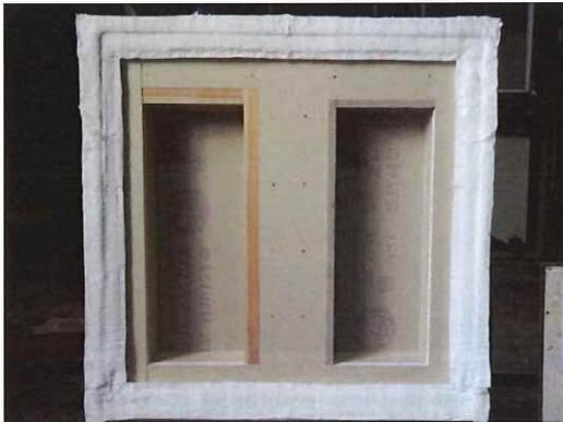
写真 15-1 加熱面・実験前（試験体 5-1）
