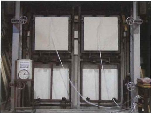
写真 15-9 非加熱面・実験開始 75 分後
