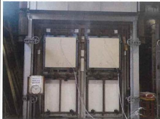
写真 17-12 非加熱面・実験開始 110 分後
