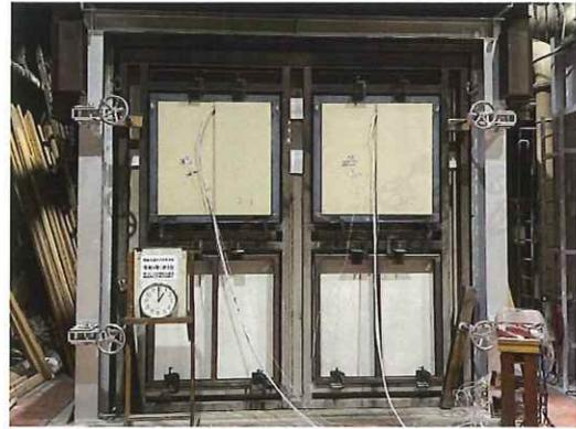
写真 9-8 非加熱面・実験開始 60 分後
