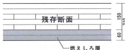
図3.3-4 CLT床版の残存断面
