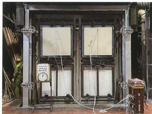
写真 7-8 非加熱面・実験開始 60 分後
