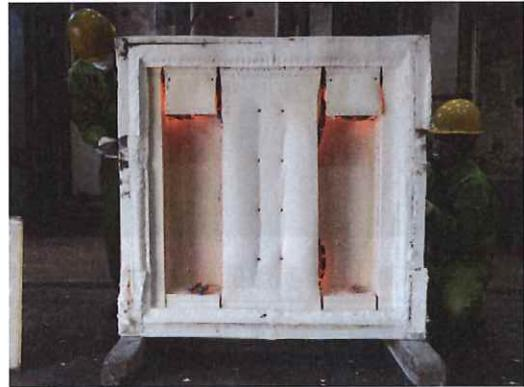
写真 13-4 加熱面・加熱 110 分後
