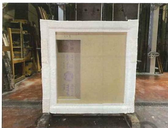
写真2 試験体1-1(小型壁)の加熱面の様子
