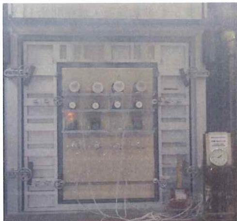
写真 5-11 非加熱面・加熱開始 108 分後
