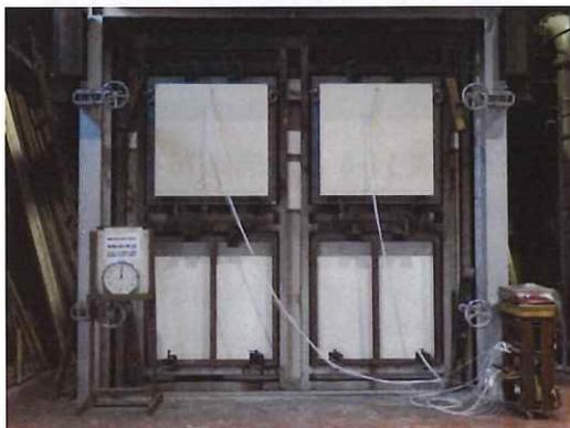
写真 15-5 非加熱面・実験開始時
