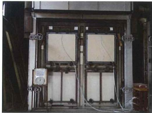
写真 17-8 非加熱面・実験開始 60 分後
