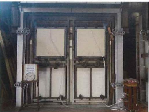
写真 13-11 非加熱面・実験開始 108 分後
