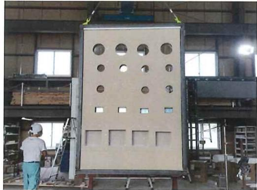
大型壁（試験体 1）の加熱側被覆の施工状況
