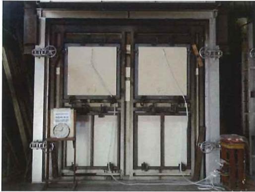
写真 13-7 非加熱面・実験開始 45 分後
