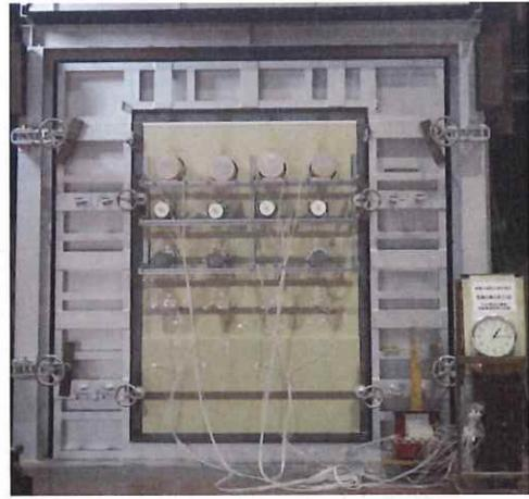
写真 5-8 非加熱側・加熱開始 75 分後
