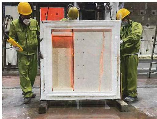
写真 7-4 加熱面・加熱 110 分後
