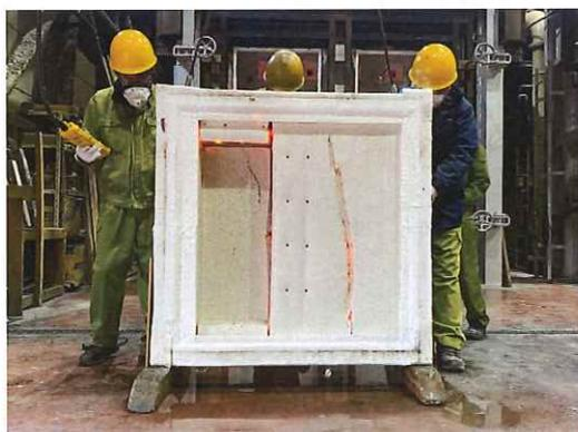
写真 7-3 加熱面・加熱 110 分後
