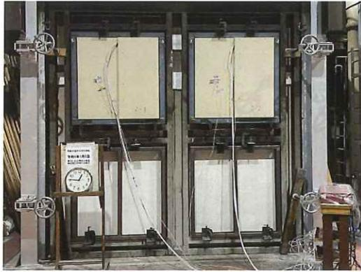
写真 9-7 非加熱面・実験開始 45 分後
