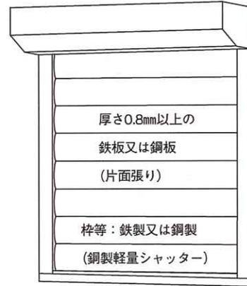
図2.9.2-2 鉄製又は鋼製シャッター一例
