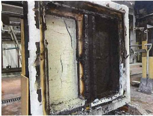
写真 7-15 構造躯体・解体時（試験体 1-1）
