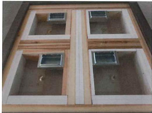
小型壁（試験体 3-2・切欠部）の壁内の施工状況
