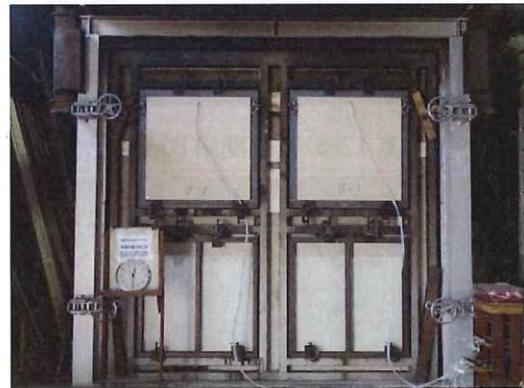
写真 13-6 非加熱面・実験開始 30 分後
