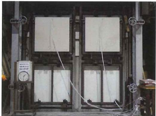
写真 15-10 非加熱面・実験開始 90 分後
