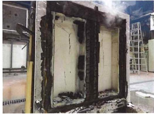
写真 15-16 構造躯体・解体時（試験体 5-2）
