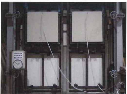
写真 15-12 非加熱面・実験開始 110 分後
