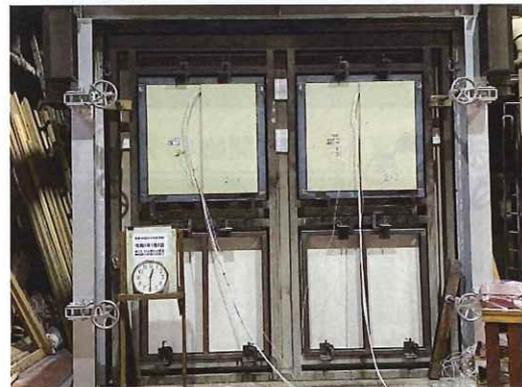
写真 9-6 非加熱面・実験開始 30 分後
