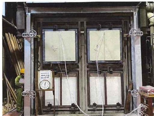
写真 7-6 非加熱面・実験開始 30 分後
