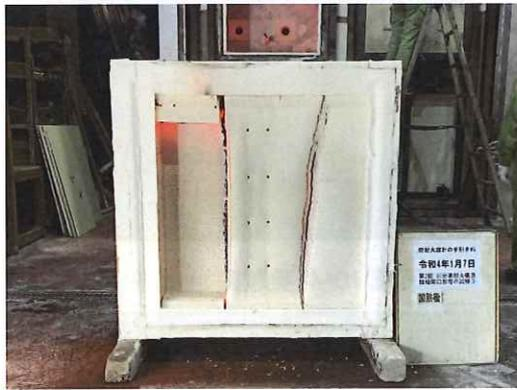
写真 11-3 加熱面・加熱 110 分後
