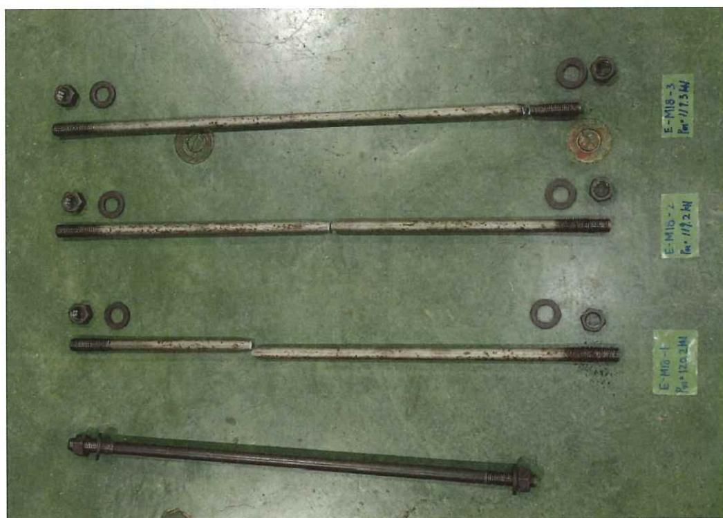
写真 4.6 ポルト引張試験終了時
