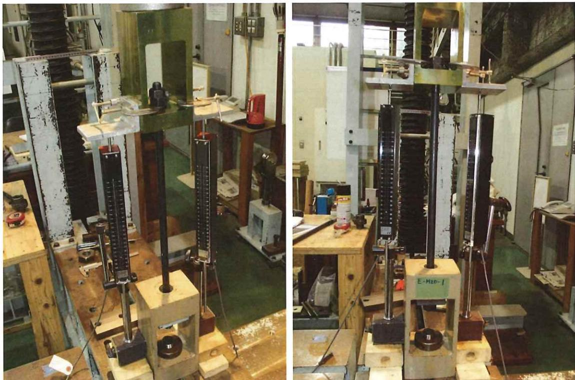
写真 4.5 ポルト引張試験状況
